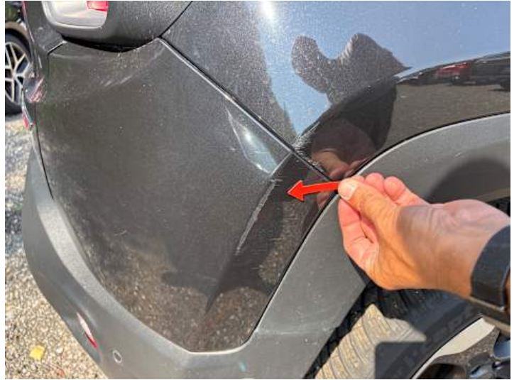
Stoßstange hinten (Kratzer, Lackschaden)
