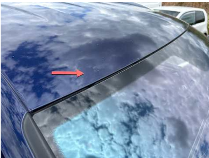
Windschutzscheibe (Anderer Schaden): Unsachgemäß Instandgesetzt
