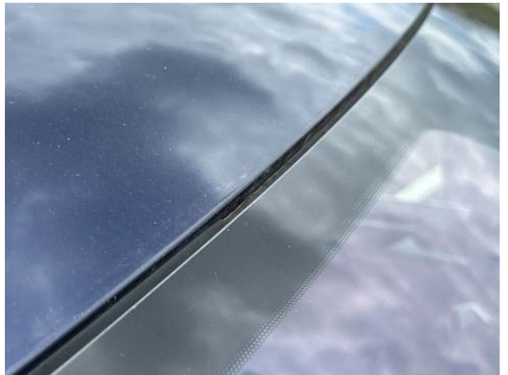
Windschutzscheibe (Anderer Schaden): Unsachgemäß Instandgesetzt
