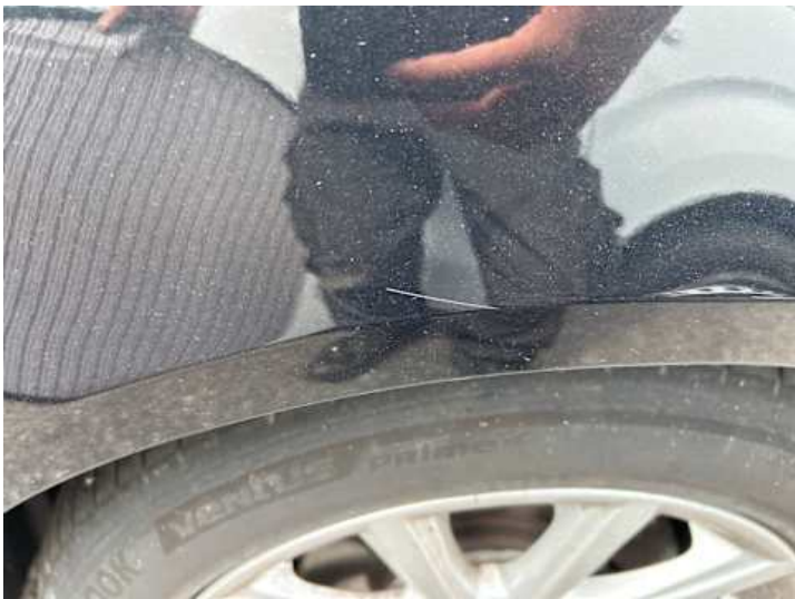
Kotflügel vorne rechts (Kratzer, Lackschaden)
