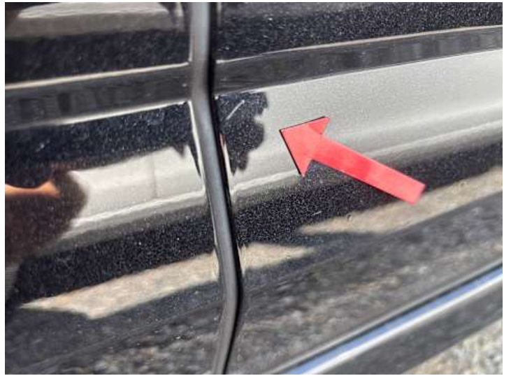
Beifahrertür (Unsachgemäß instand gesetzt)
