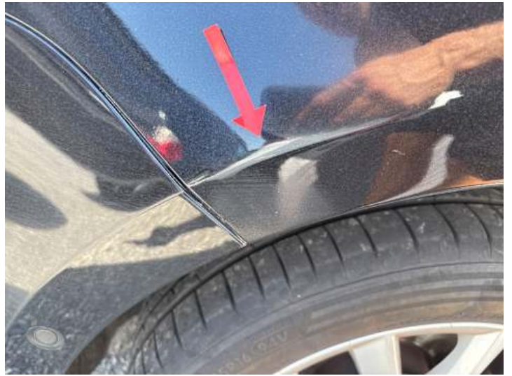
Seitenteil hinten rechts (Unsachgemäß instand gesetzt)
