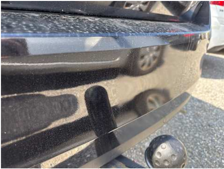
Stoßstange hinten (Unsachgemäß instand gesetzt)
