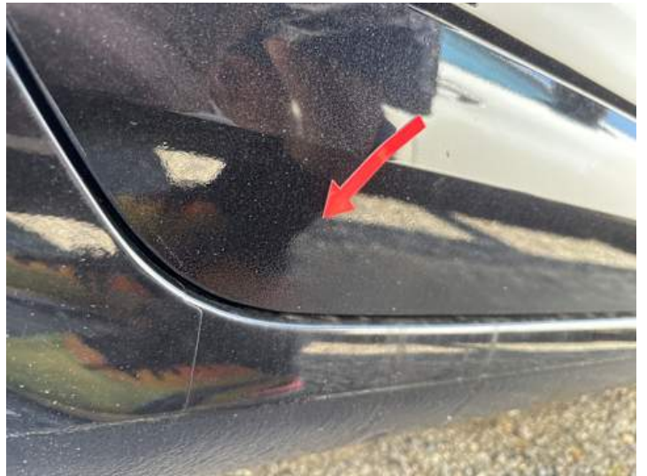
Türe hinten rechts (Unsachgemäß instand gesetzt)
