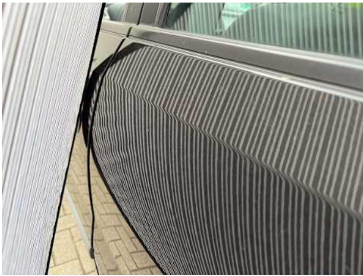
Türe hinten links (Delle)
