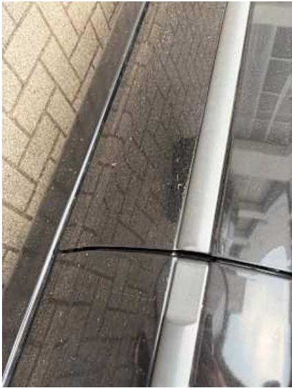
Fahrtür (Lackschaden, Kratzer)
