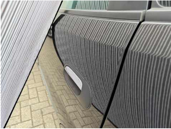
Türe hinten links (Delle)
