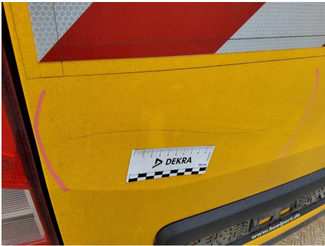
Hecktüre links Lackierung, zerkratzt, lackieren (DEKRA)
