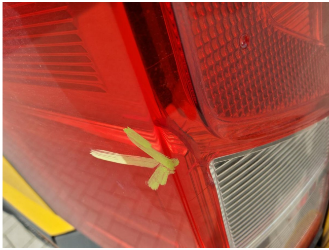
Rückleuchte links beschädigt (DEKRA)
