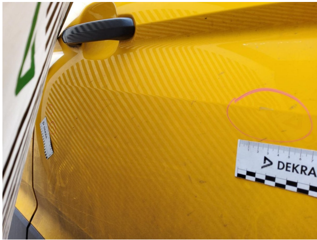
Tür vorne rechts, mehrfach eingedellt, drücken (DEKRA)
