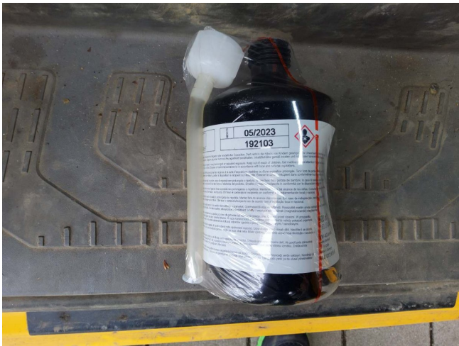
Reifendichtmittel abgelaufen (DEKRA)
