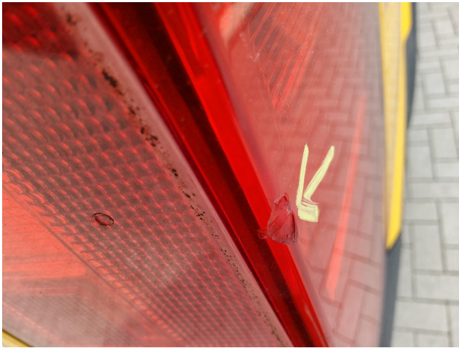
Rückleuchte rechts beschädigt (DEKRA)
