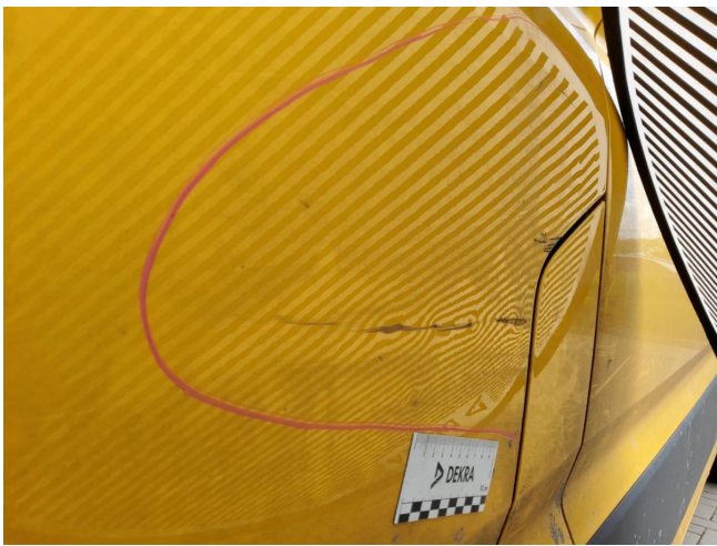
Tür vorne links, deformiert, instandsetzen und lackieren mit Lackaufbau (DEKRA)
