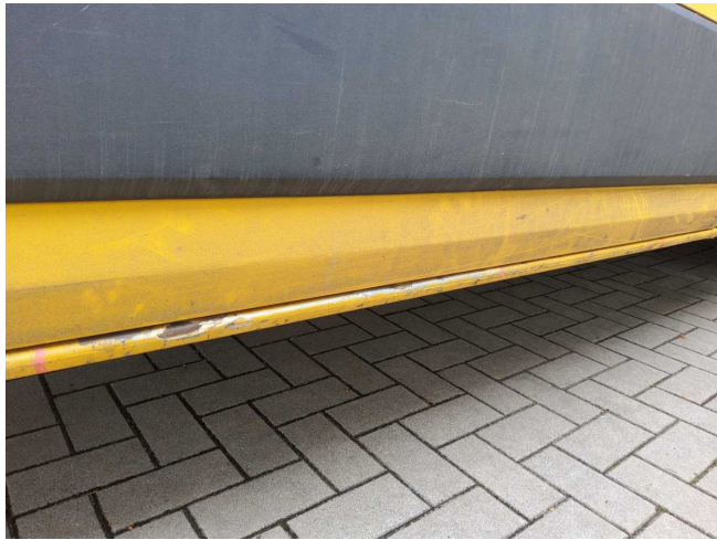
Unterholm rechts mehrfach eingedrückt (DEKRA)
