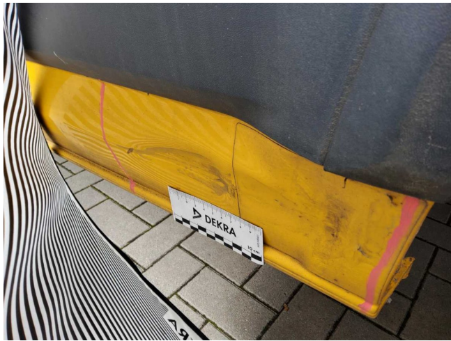
Seitenwand (lang) hinten links, vorne, deformiert, instandsetzen und lackieren mit Lackaufbau (DEKRA..
