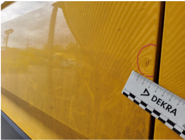
Schiebetür rechts Lackierung unterhalb, verschrammt, smart repair (DEKRA)
