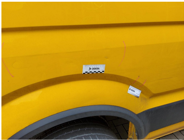
Seitenwand (lang) hinten rechts, hinten, deformiert, instandsetzen und lackieren mit Lackaufbau (DE..
