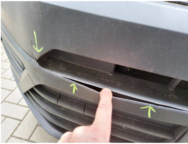
Stoßfänger vorne beschädigt (gerissen) (DEKRA)
