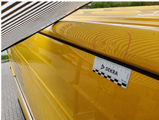
Dachrahmen mitte rechts außen, mehrfach eingedellt, smart repair (DEKRA)
