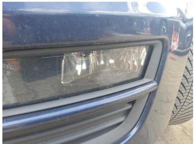
Nebelscheinwerfer erneuern VL gebrochen
