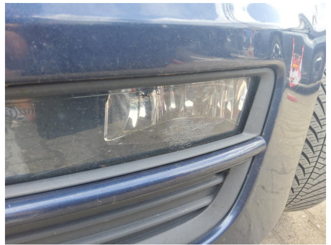
Nebelscheinwerfer erneuern VL gebrochen
