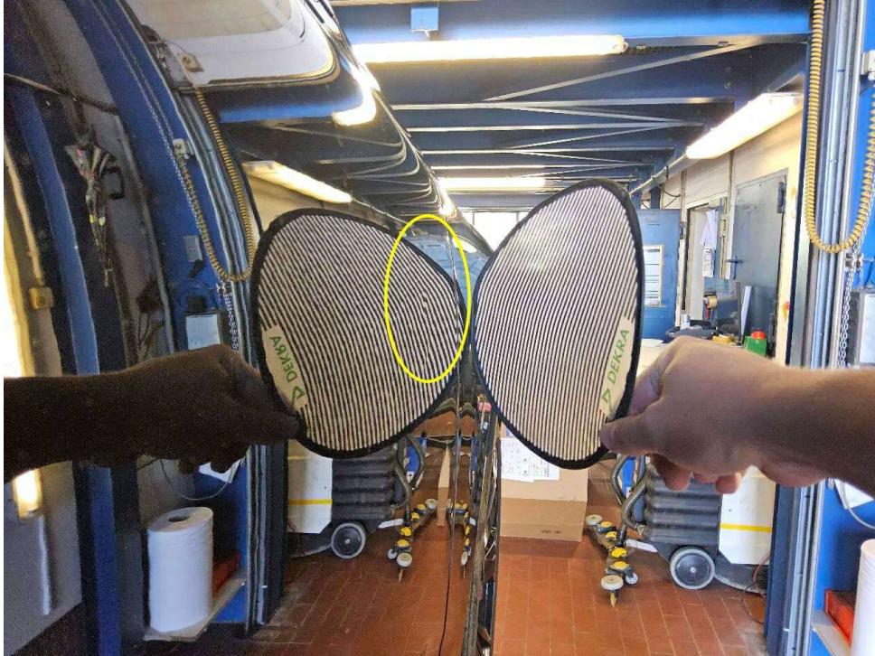
Bild 9 : Tür vorne rechts eingedellt und unterhalb nicht fachgerecht instandgesetzt
