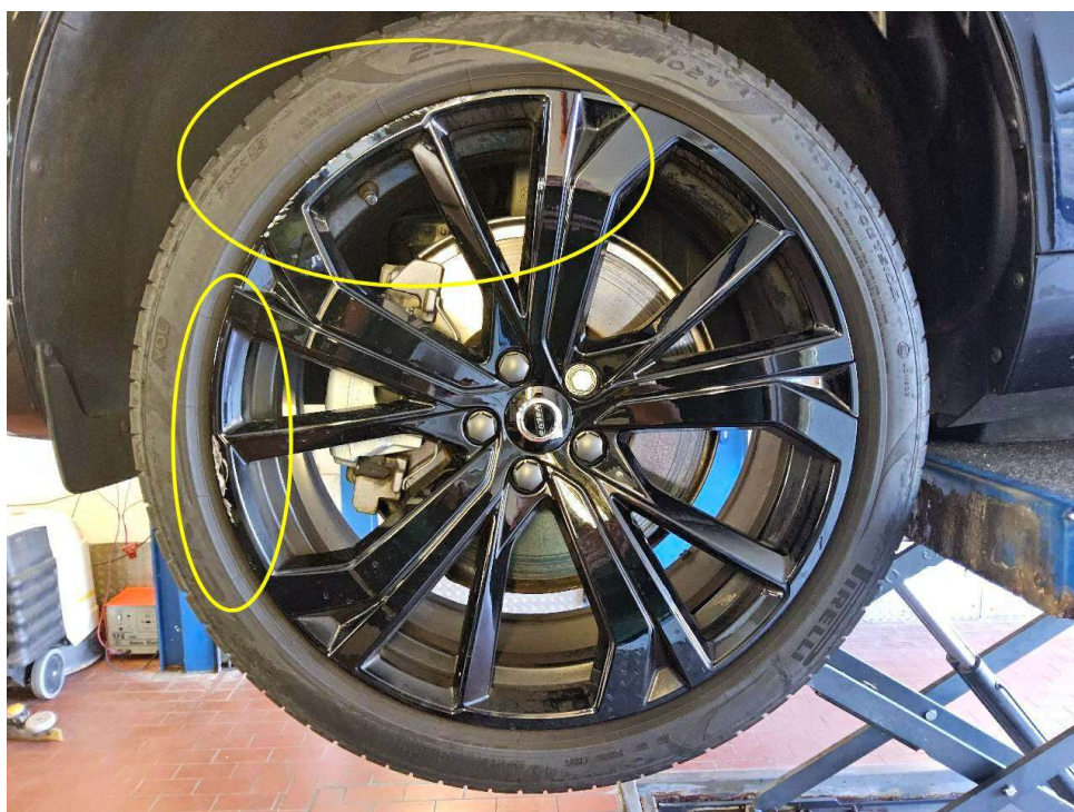
Bild 12 : Lackierte Felge vorne links mehrfach verschrammt
