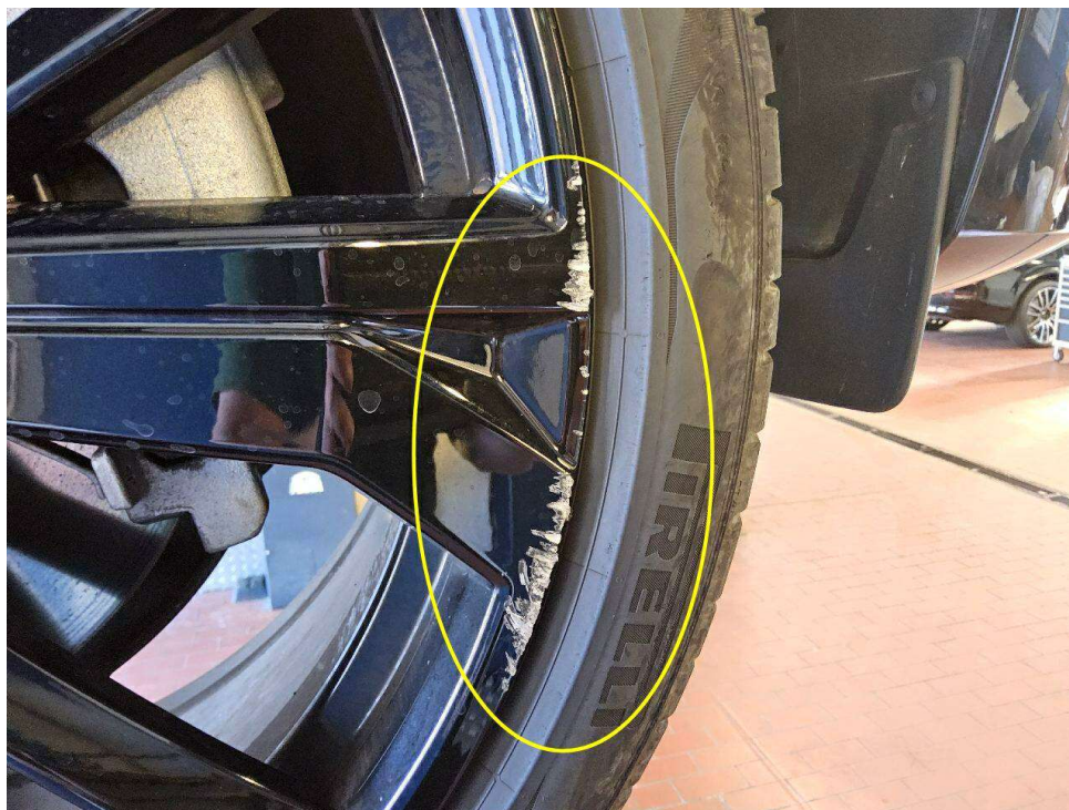
Bild 16 : Lackierte Felge vorne rechts mehrfach verschrammt
