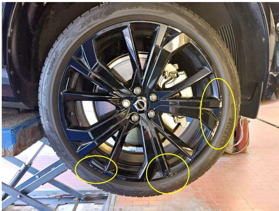
Bild 15 : Lackierte Felge vorne rechts mehrfach verschrammt
