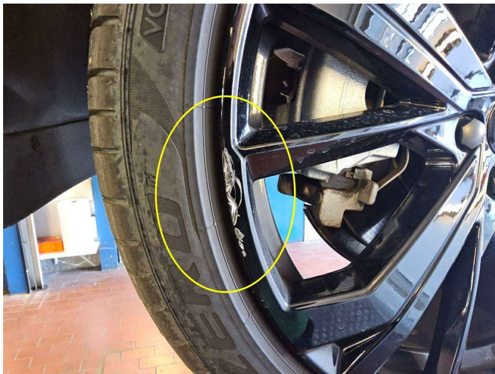
Bild 13 : Lackierte Felge vorne links mehrfach verschrammt
