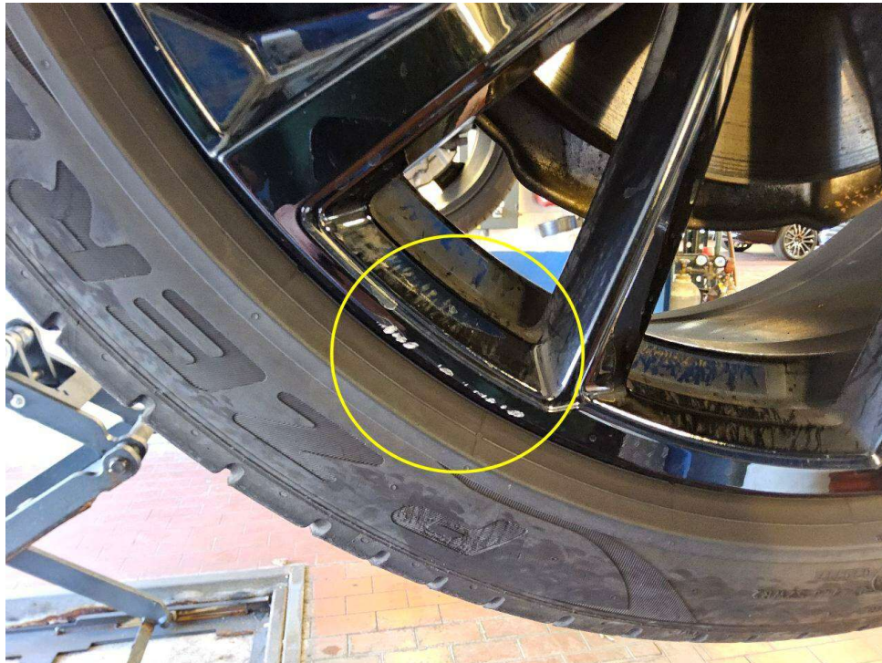
Bild 17 : Lackierte Felge vorne rechts mehrfach verschrammt
