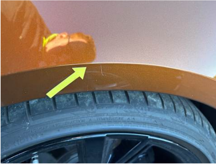
Seitenteil hinten rechts (Kratzer)
