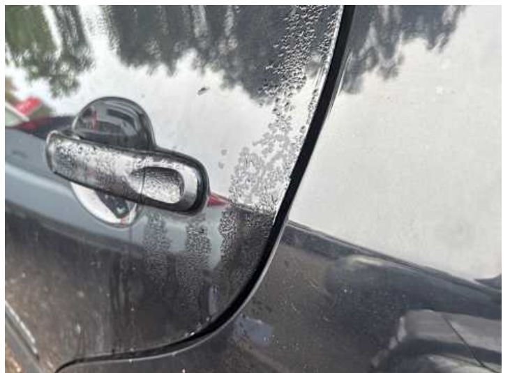
Türe hinten links (Lackschaden)
