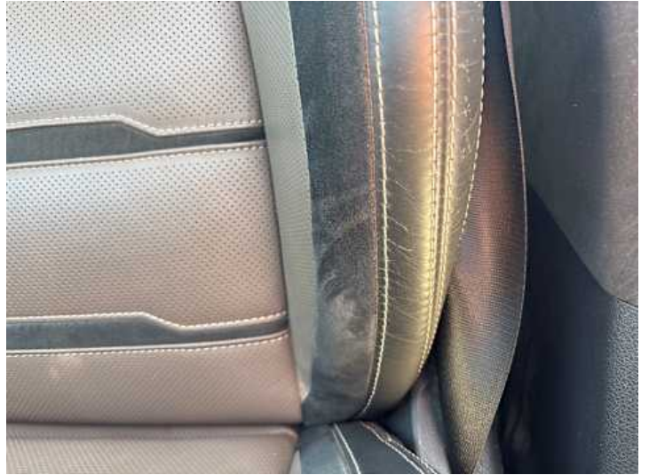
Innenraum (Kratzer, Verschleiß)
