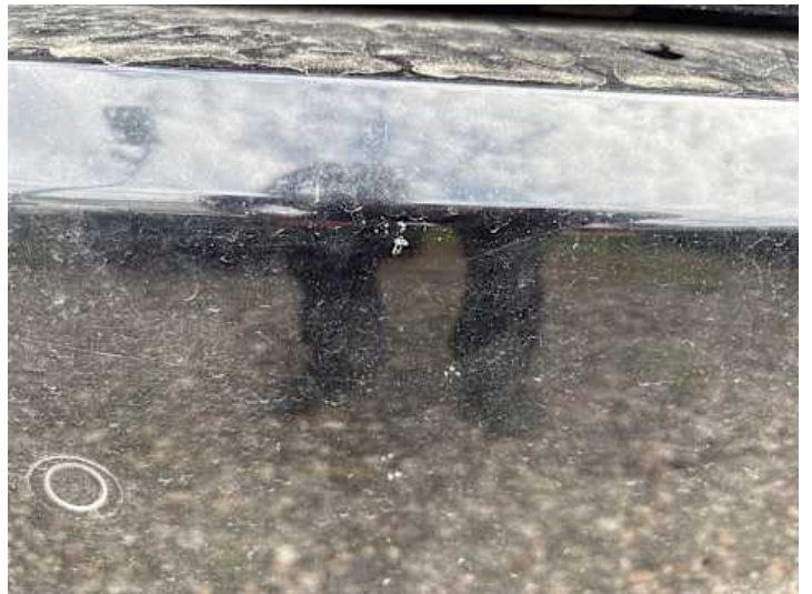
Stoßstange hinten (Lackschaden)
