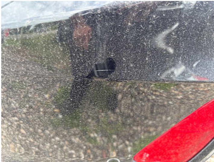
Stoßstange hinten (Kratzer, Lackschaden)
