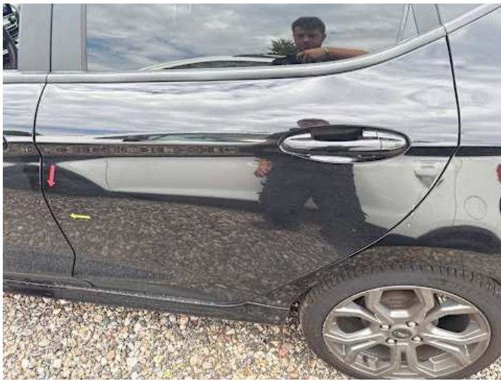
Türe hinten links (Delle, Kratzer)
