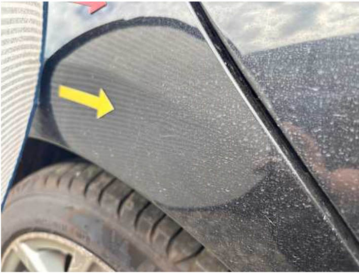
Seitenteil hinten rechts (Delle)
