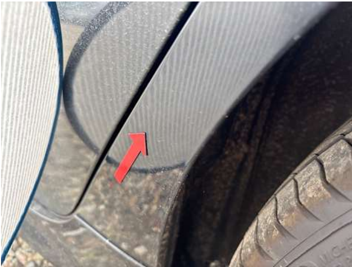
Seitenteil hinten links (Kratzer, Delle)
