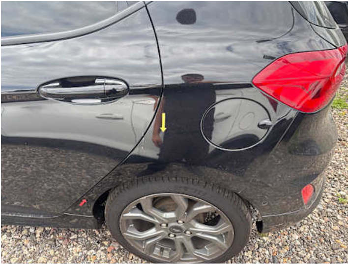
Seitenteil hinten links (Kratzer, Delle)
