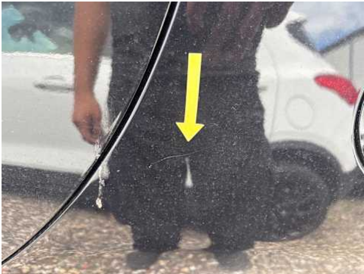
Seitenteil hinten links (Kratzer, Delle)
