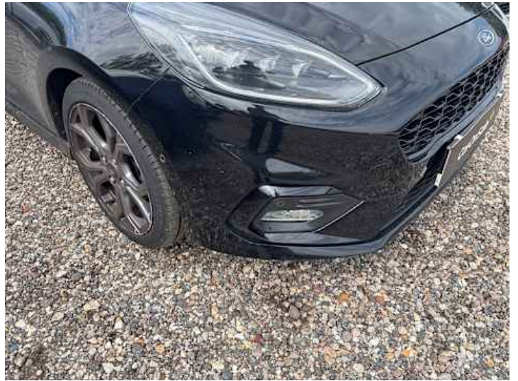
Stoßstange vorne (Lackschaden)
