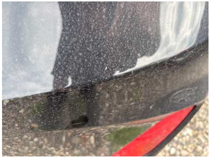
Stoßstange hinten (Kratzer, Lackschaden)
