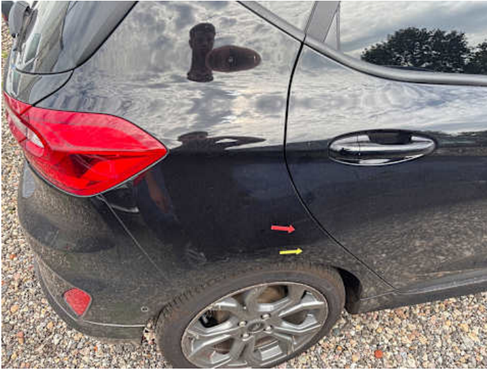
Seitenteil hinten rechts (Delle)
