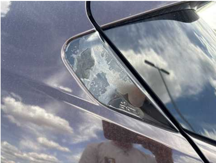
Seitenteil hinten links (Lackschaden)
