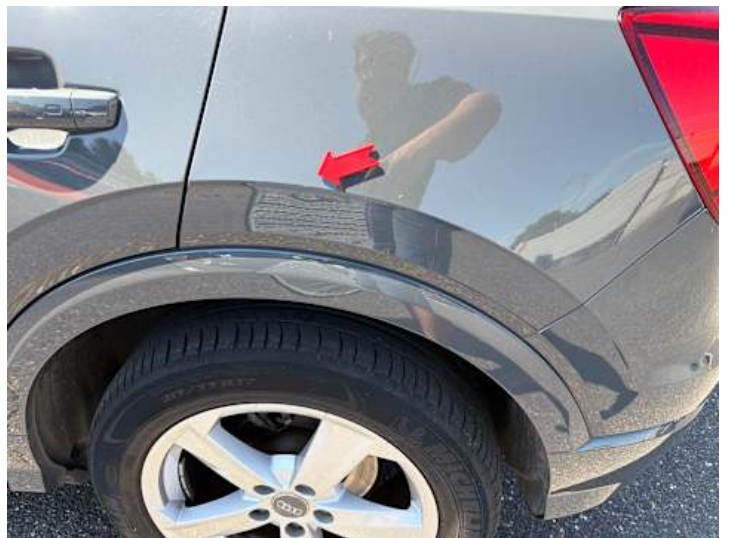
Seitenteil hinten links (Delle, Lackschaden)
