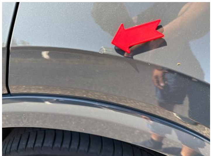
Seitenteil hinten links (Delle, Lackschaden)
