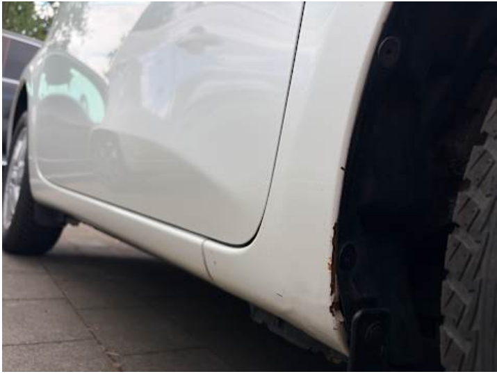
Kotflügel vorne rechts (Rost)
