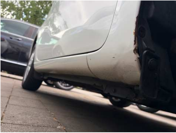
Schweller rechts (Rost, Verformung)
