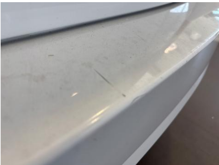
Stoßstange hinten (Lackschaden, Kratzer)
