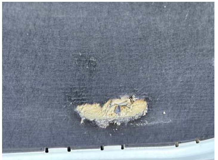
Motorhaube (Anderer Schaden): Motordämmung beschädigt
