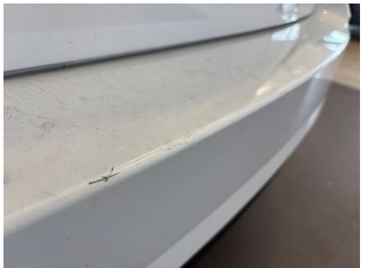
Stoßstange hinten (Lackschaden, Kratzer)
