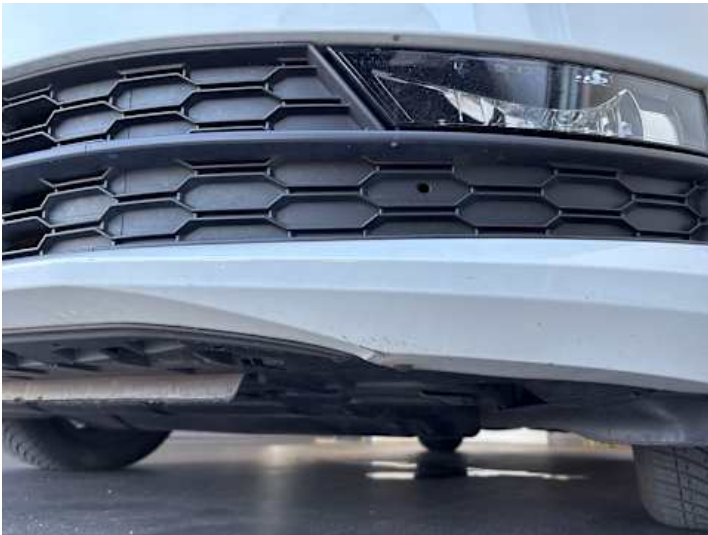
Stoßstange vorne (Lackschaden)
