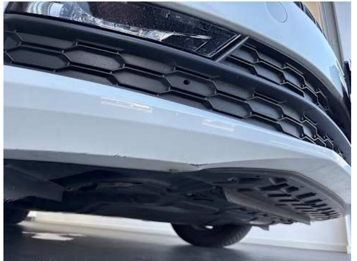
Stoßstange vorne (Lackschaden)
