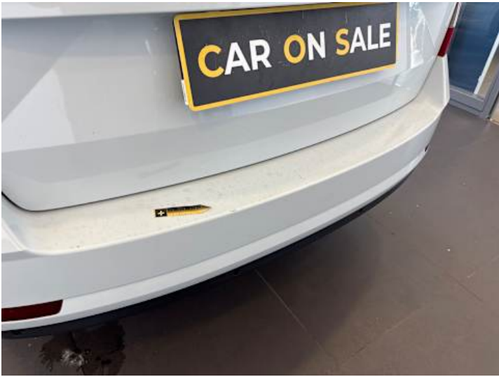
Stoßstange hinten (Lackschaden, Kratzer)
