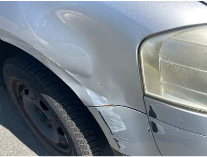
Kotflügel vorne rechts (Rost, Kratzer, Verformung)
