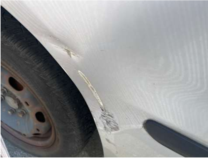
Seitenteil hinten rechts (Verformung, Kratzer)
