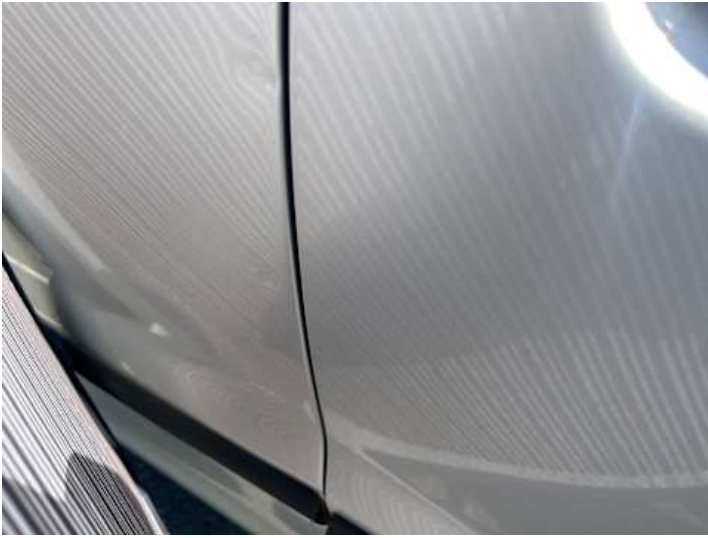
Seitenteil hinten rechts (Verformung)
