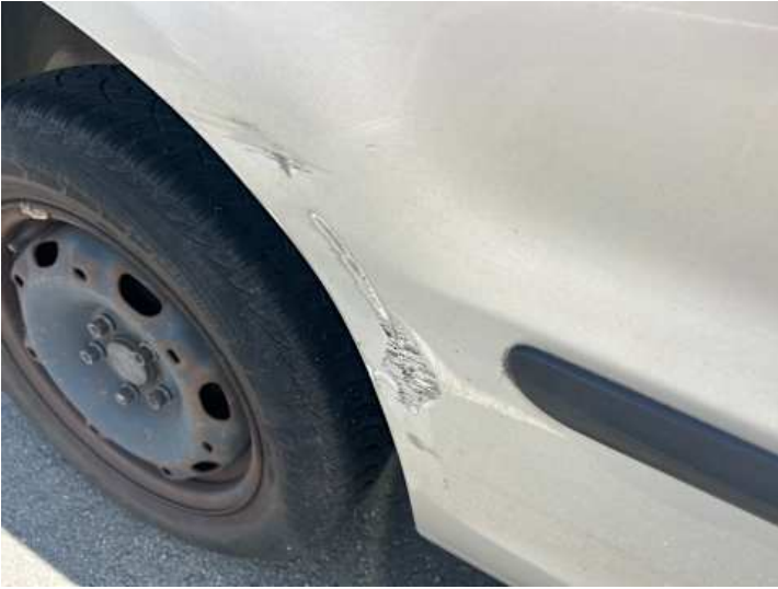
Seitenteil hinten rechts (Verformung, Kratzer)
