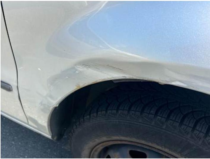
Kotflügel vorne rechts (Rost, Kratzer, Verformung)
