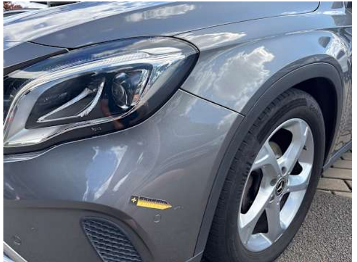
Stoßstange vorne (Kratzer)
