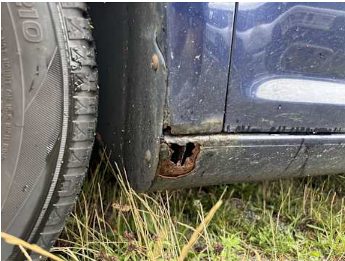
Kotflügel vorne links (Rost, Riss/Bruch)
