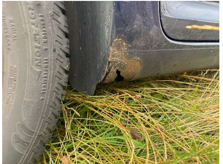
Schweller rechts (Rost, Riss/Bruch)
