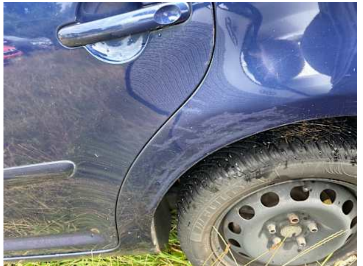
Seitenteil hinten links (Lackschaden, Unsachgemäß instand gesetzt)
