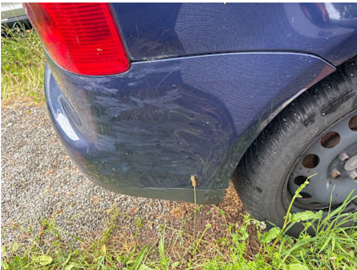
Stoßstange hinten (Spaltmaße ungenau, Lackschaden, Unsachgemäß instand gesetzt)
