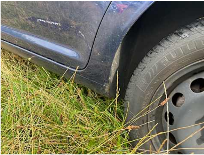
Schweller links (Rost)
