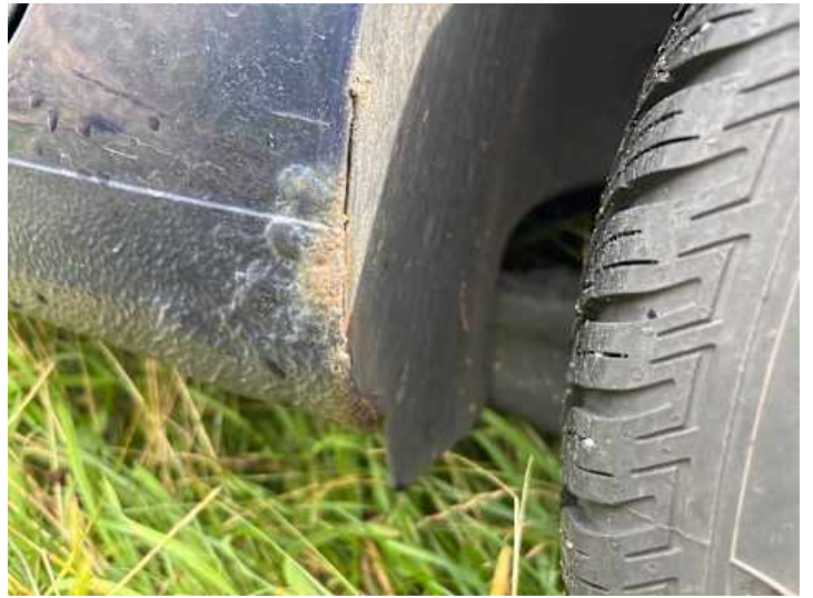
Schweller links (Rost)
