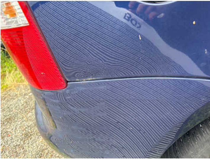
Seitenteil hinten rechts (Verformung)
