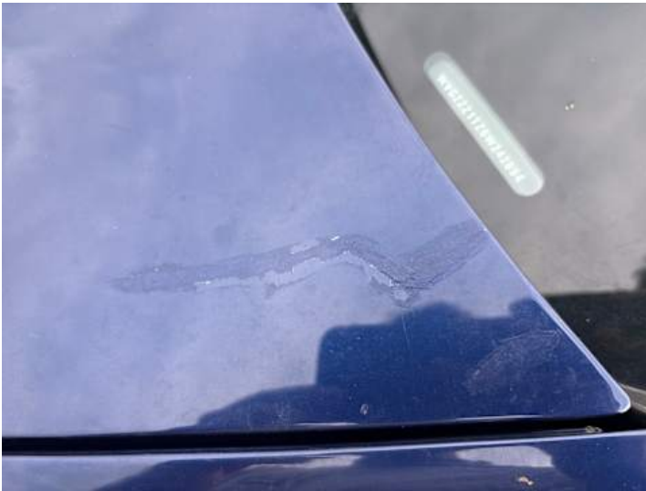
Motorhaube (Lackschaden, Unsachgemäß instand gesetzt)
