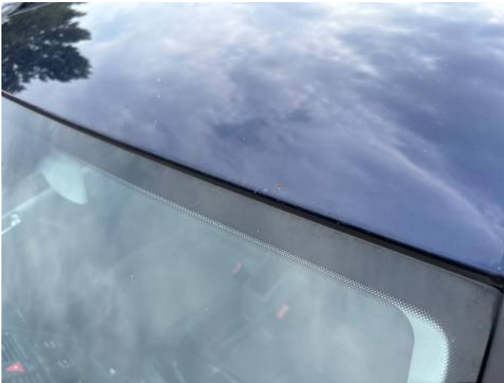
Dach (Steinschlag, Rost)
