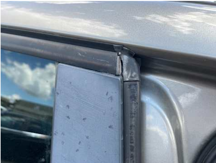
Türe hinten rechts (Riss/Bruch)
