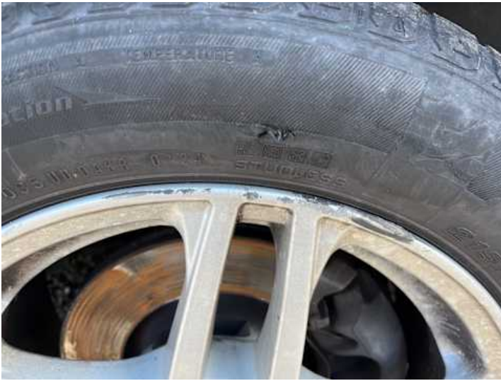
Rad (Kratzer, Riss/Bruch)
