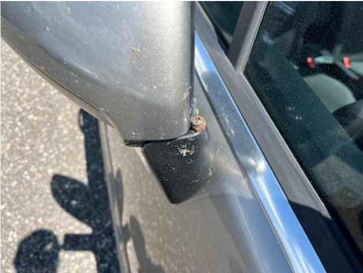
Beifahrtür (Unsachgemäß instand gesetzt)
