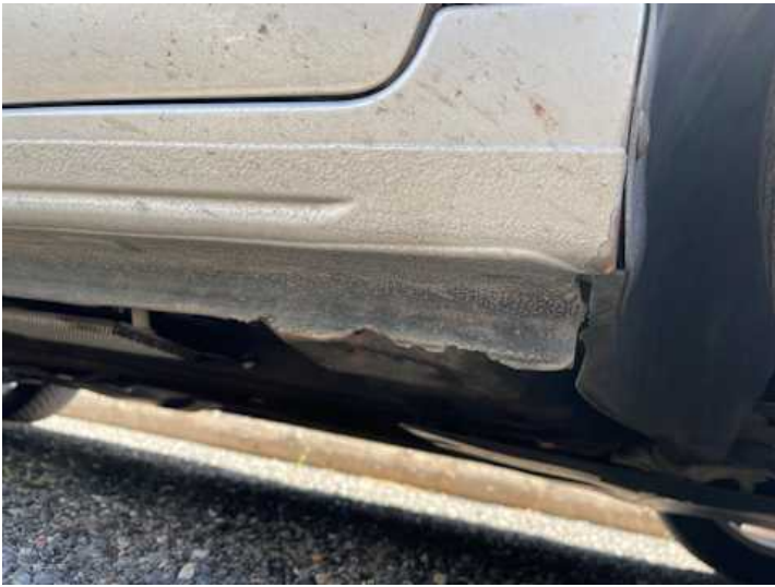
Schweller rechts (Rost, Lackschaden)
