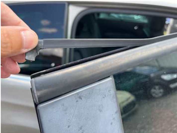
Türe hinten rechts (Riss/Bruch)
