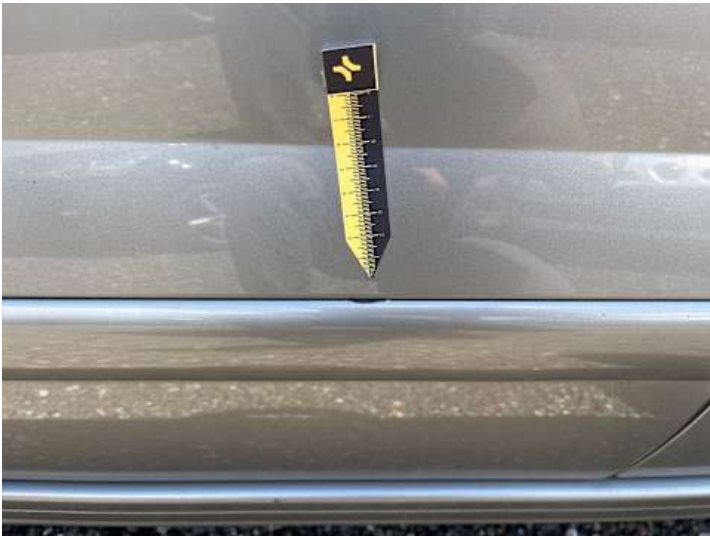
Türe hinten rechts (Lackschaden)
