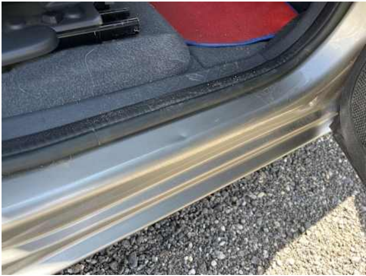
Schweller rechts (Delle)
