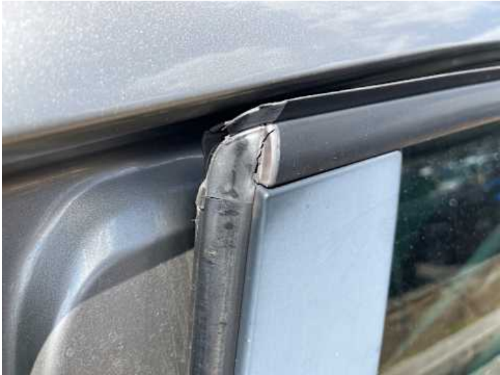
Türe hinten links (Riss/Bruch)
