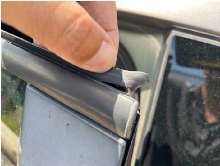
Türe hinten links (Riss/Bruch)
