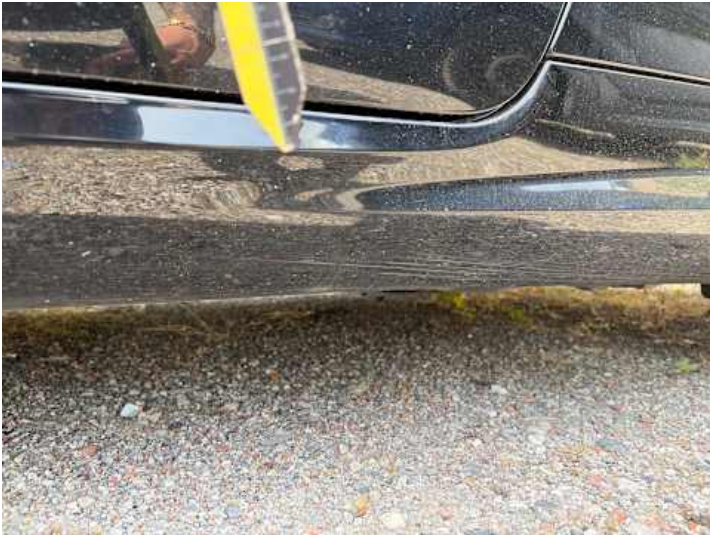
Schweller links (Lackschaden, Kratzer)
