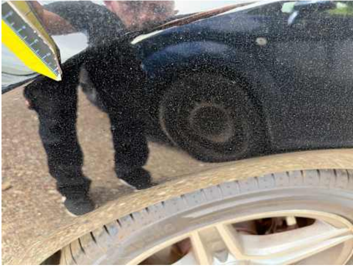
Seitenteil hinten links (Lackschaden, Kratzer)
