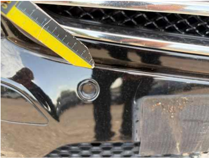
Stoßstange vorne (Lackschaden, Kratzer)
