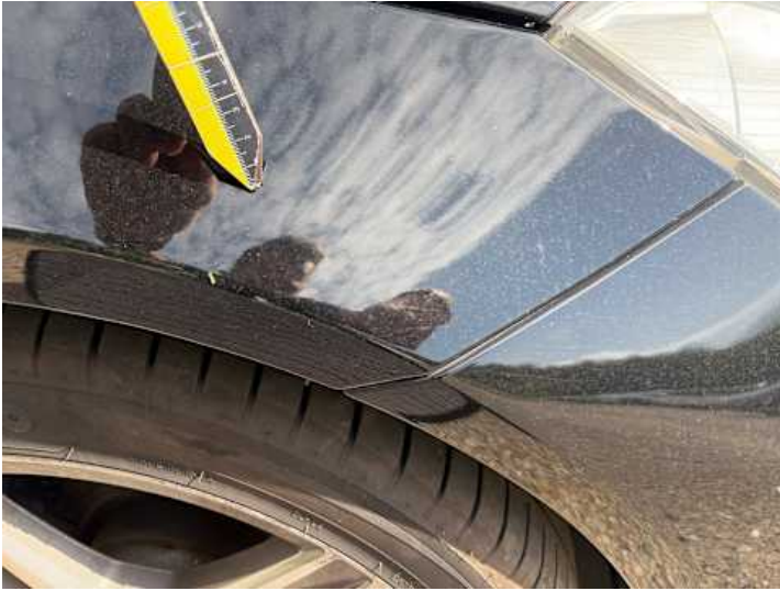
Kotflügel vorne rechts (Lackschaden, Kratzer)
