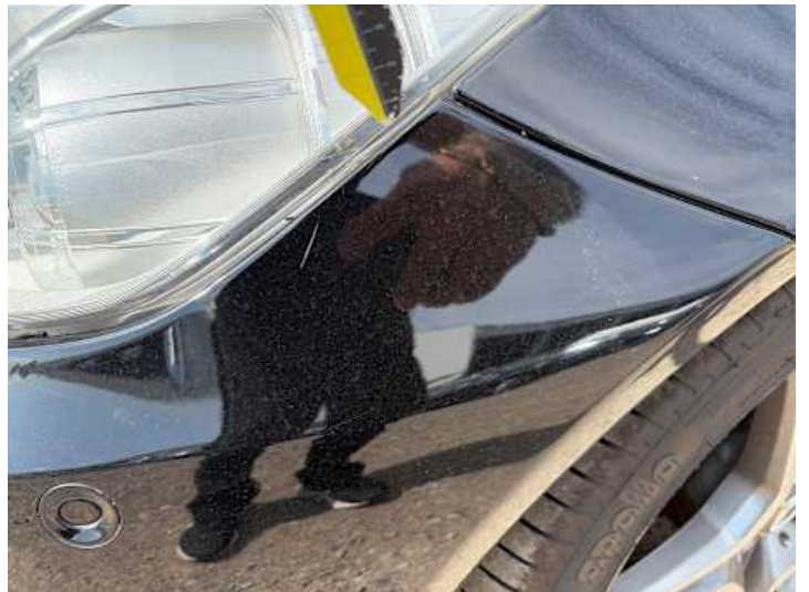
Stoßstange vorne (Lackschaden, Kratzer)
