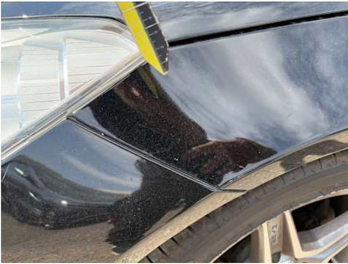
Kotflügel vorne links (Lackschaden, Kratzer)
