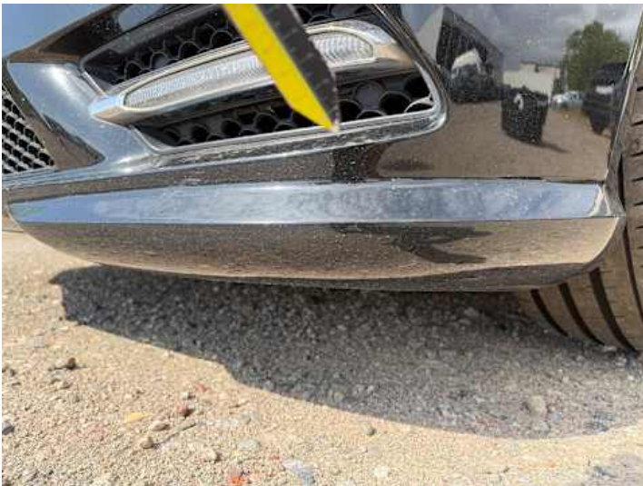
Stoßstange vorne (Lackschaden, Kratzer)
