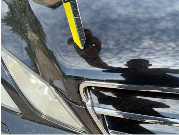
Motorhaube (Lackschaden, Kratzer, Steinschlag)
