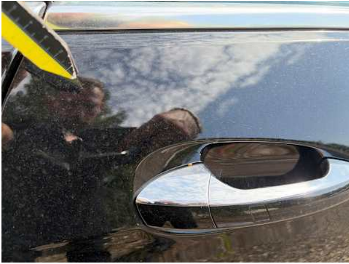
Beifahrtür (Lackschaden, Kratzer)
