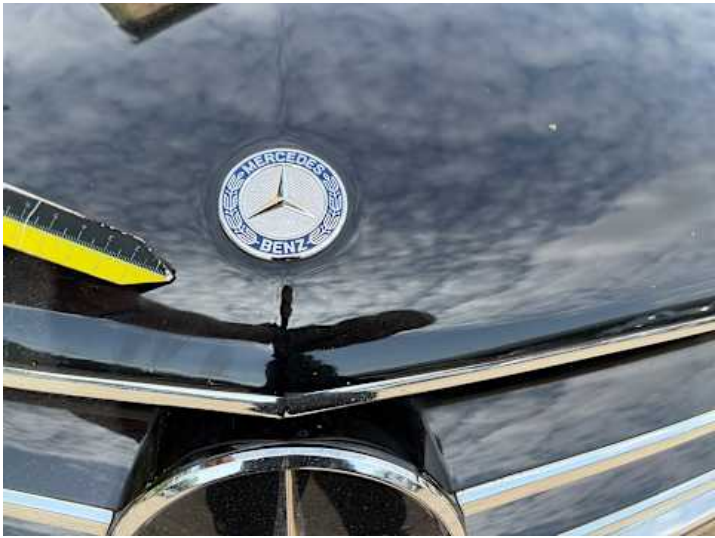
Motorhaube (Lackschaden, Kratzer, Steinschlag)
