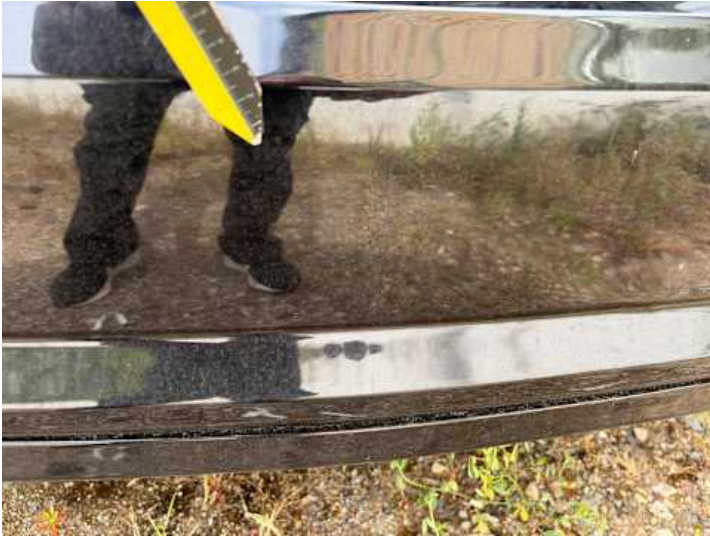
Stoßstange hinten (Lackschaden, Kratzer)
