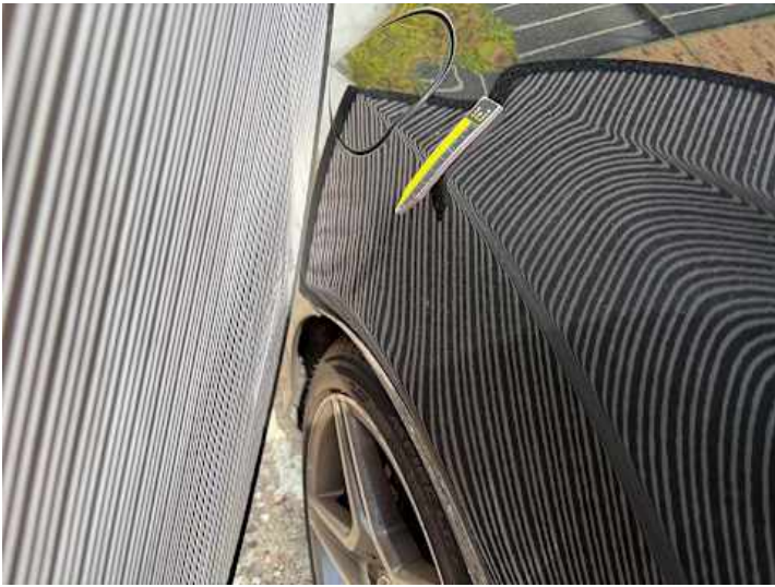
Seitenteil hinten rechts (Delle)
