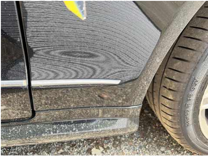
Kotflügel vorne rechts (Lackschaden, Kratzer)
