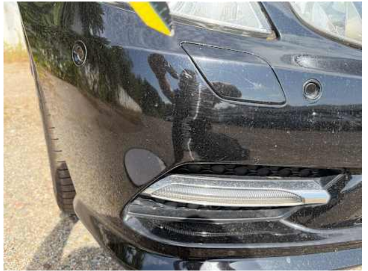
Stoßstange vorne (Lackschaden, Kratzer)
