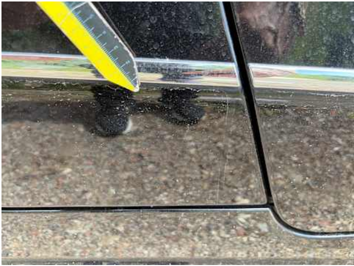
Seitenteil hinten rechts (Lackschaden, Kratzer)
