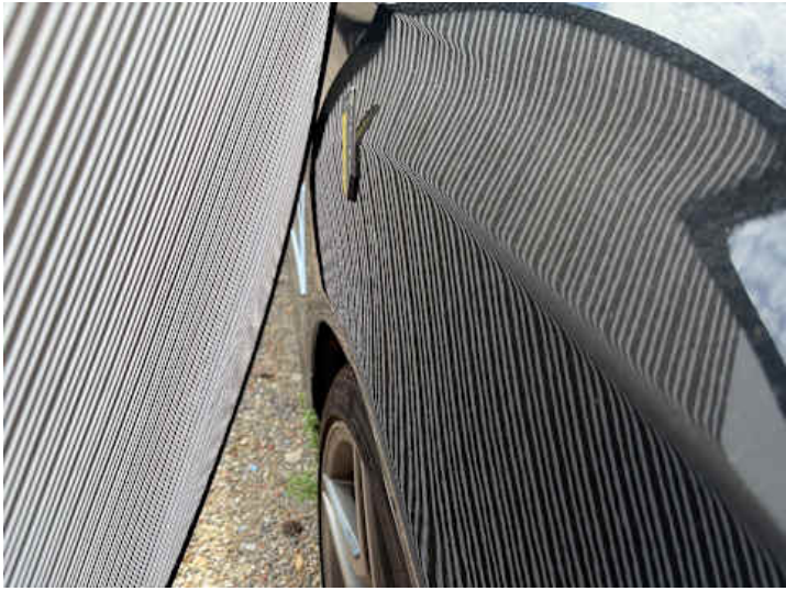
Seitenteil hinten links (Delle)
