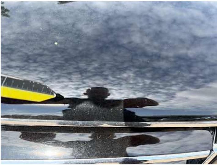
Motorhaube (Lackschaden, Kratzer, Steinschlag)
