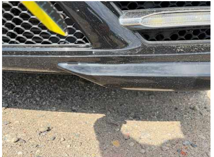
Stoßstange vorne (Lackschaden, Kratzer)
