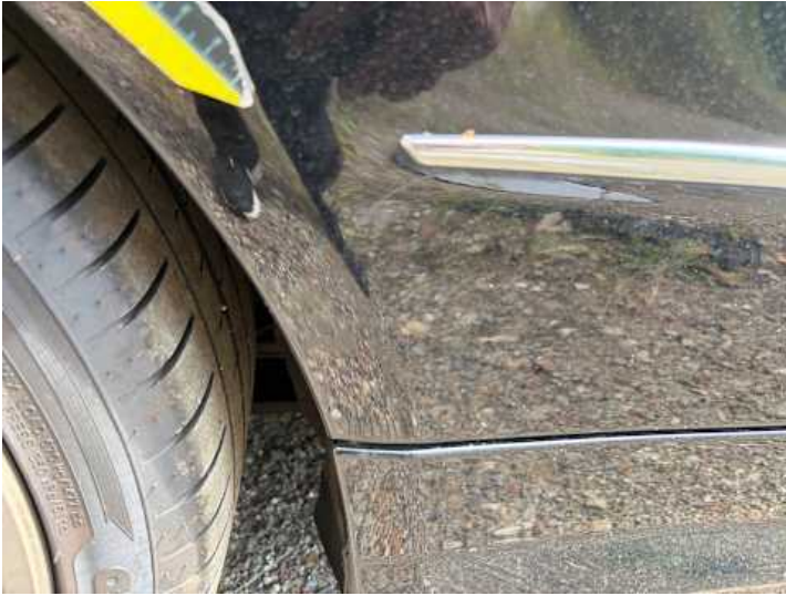
Seitenteil hinten rechts (Lackschaden, Kratzer)
