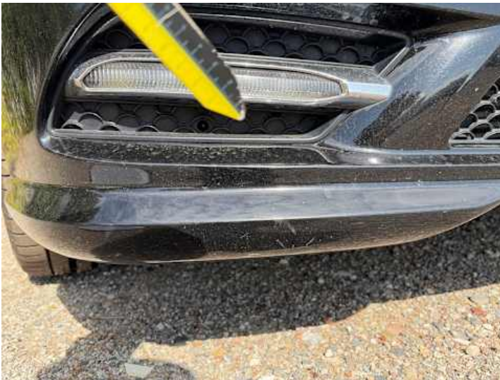
Stoßstange vorne (Lackschaden, Kratzer)
