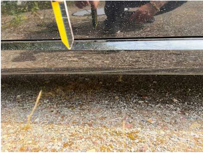
Schweller rechts (Kratzer, Lackschaden)
