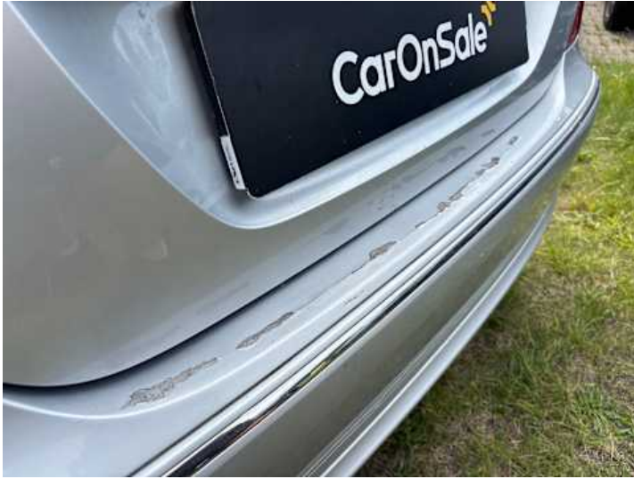
Stoßstange hinten (Kratzer, Riss/Bruch)
