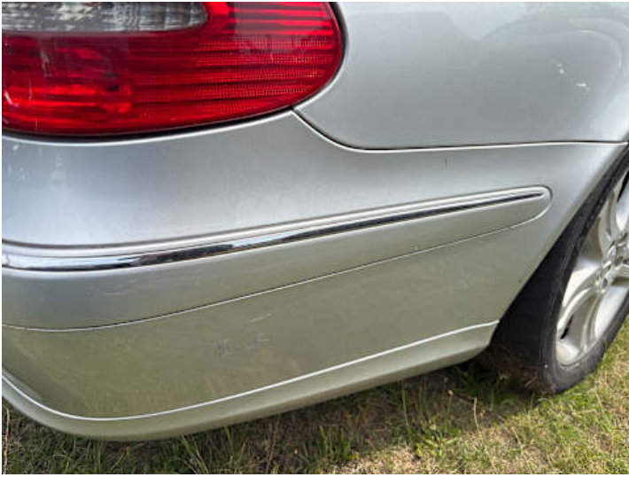
Stoßstange hinten (Kratzer, Riss/Bruch)
