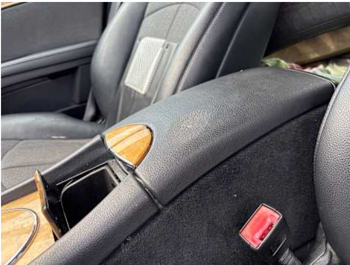
Innenraum (Verschleiß, Riss/Bruch)
