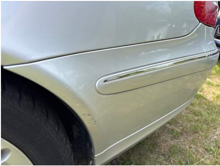
Stoßstange hinten (Kratzer, Riss/Bruch)
