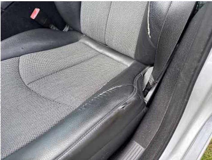
Innenraum (Verschleiß, Riss/Bruch)
