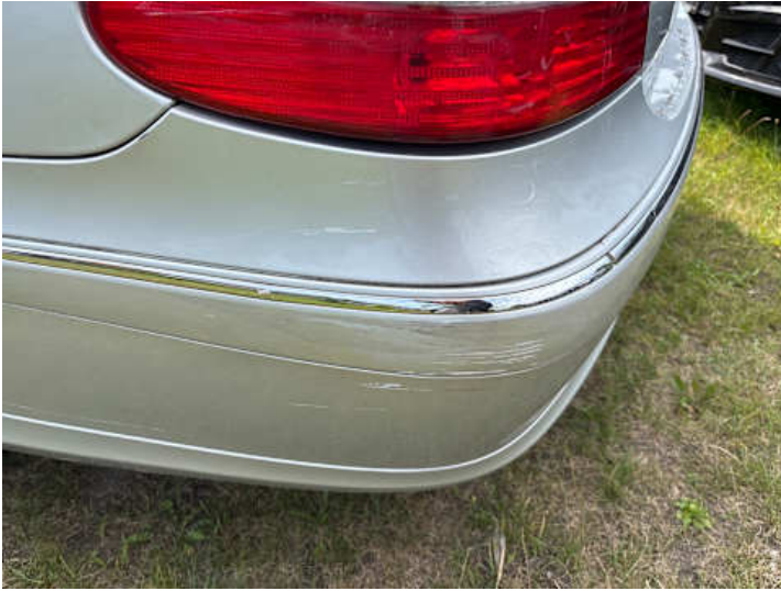
Stoßstange hinten (Kratzer, Riss/Bruch)
