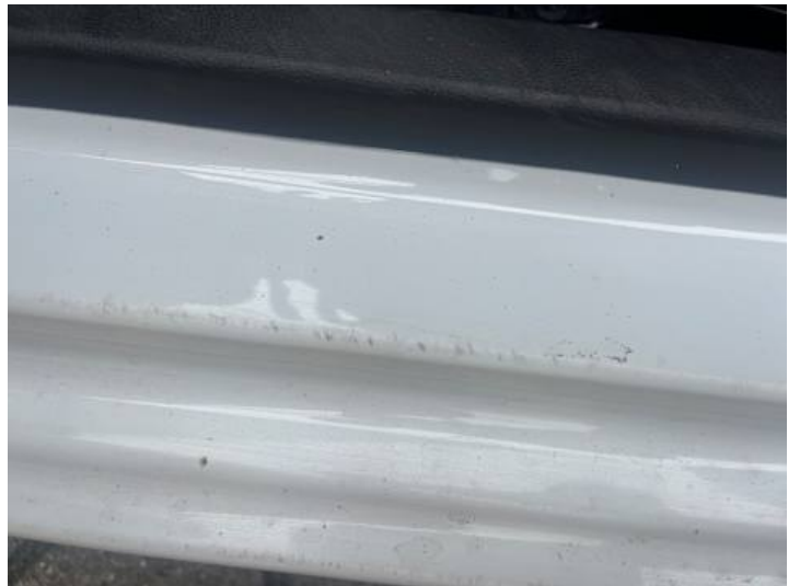
Fahrtür (Kratzer, Lackschaden)
