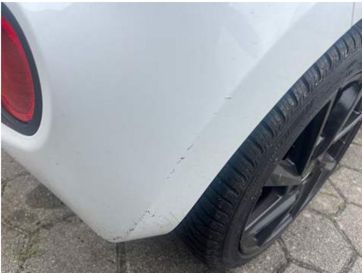
Stoßstange hinten (Kratzer, Lackschaden)
