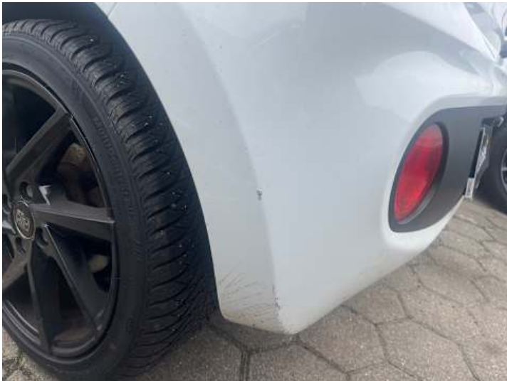
Stoßstange hinten (Kratzer, Lackschaden)
