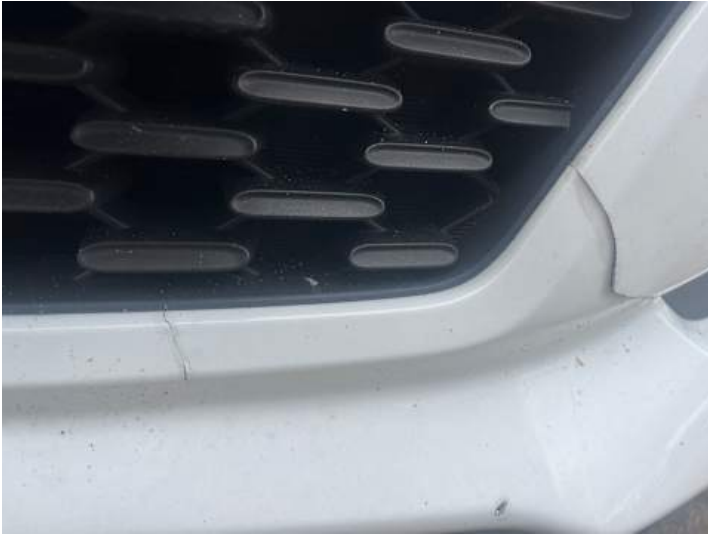
Stoßstange vorne (Riss/Bruch)
