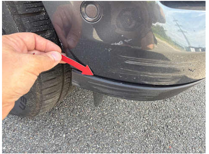
Stoßstange vorne (Spaltmaße ungenau)
