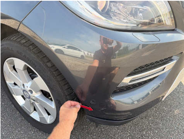
Stoßstange vorne (Spaltmaße ungenau)
