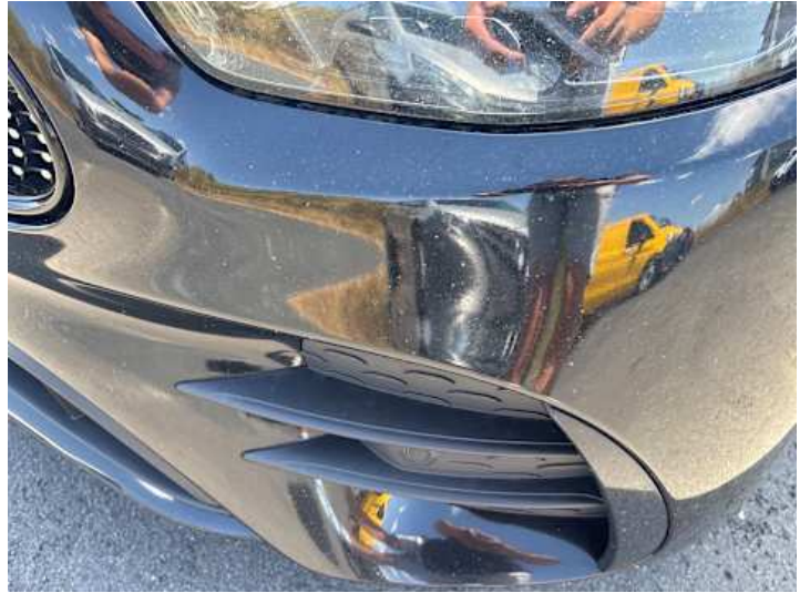
Stoßstange vorne (Steinschlag)
