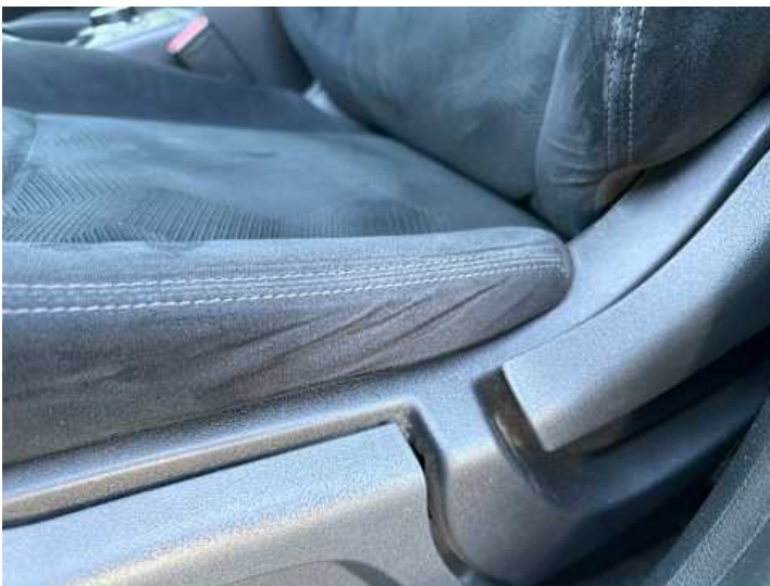
Innenraum (Verschmutzung, Verschleiß, Kratzer)
