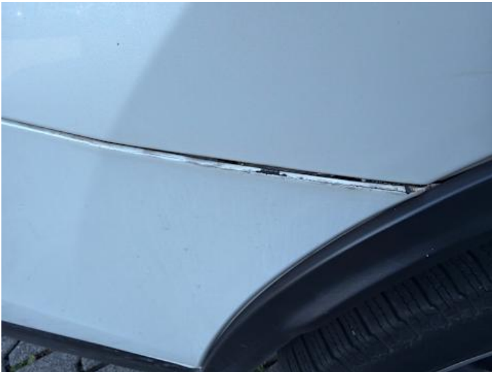
Stoßstange hinten (Lackschaden)
