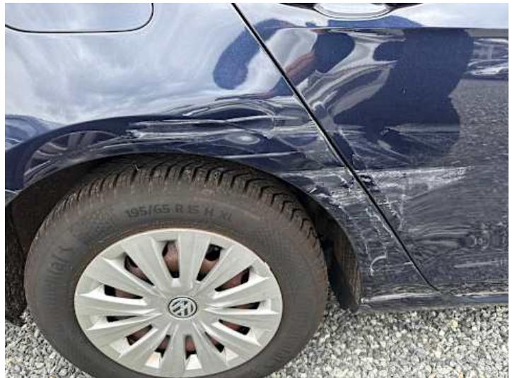
Seitenteil hinten rechts (Lackschaden, Verformung)
