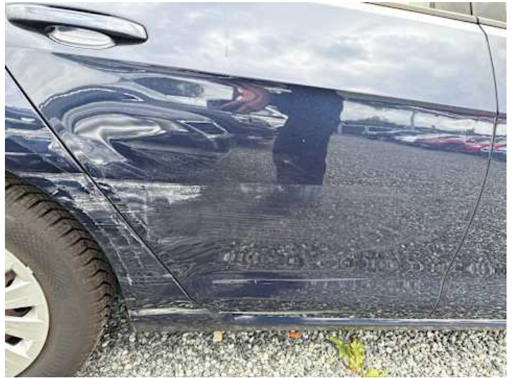
Türe hinten rechts (Lackschaden, Verformung)
