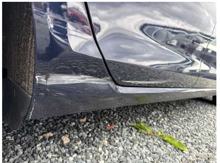
Schweller rechts (Lackschaden, Verformung)
