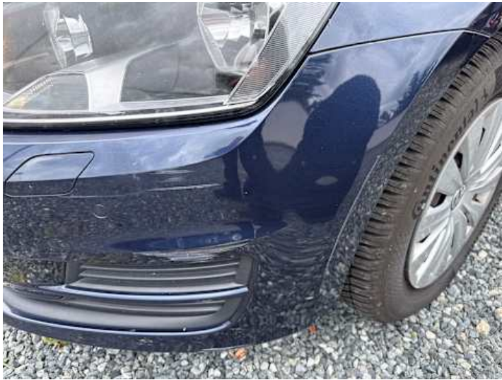
Stoßstange vorne (Lackschaden)
