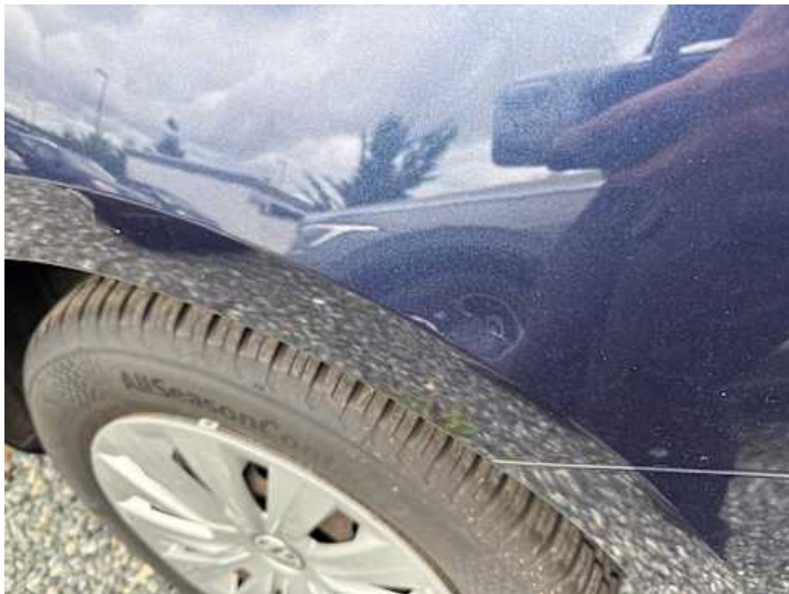
Seitenteil hinten links (Delle)
