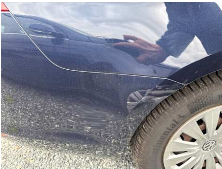
Stoßstange hinten (Lackschaden)
