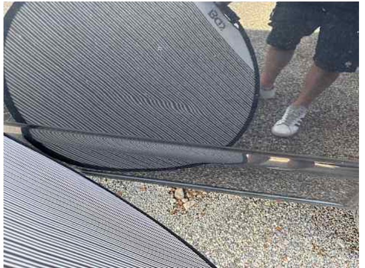
Seitenteil hinten links (Verformung)
