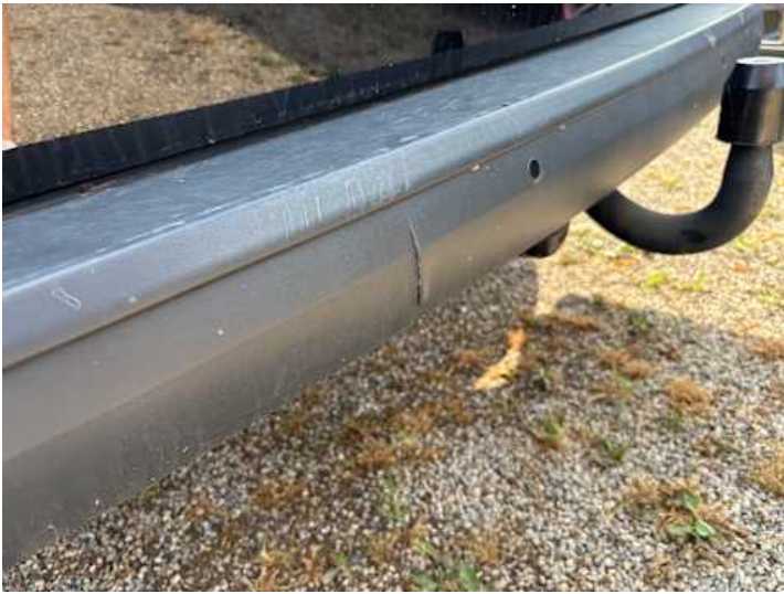
Stoßstange hinten (Riss/Bruch)
