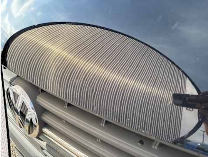
Stoßstange vorne (Delle)
