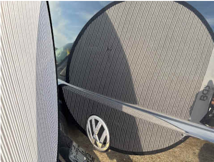
Heckklappe (Delle, Verformung, Kratzer)
