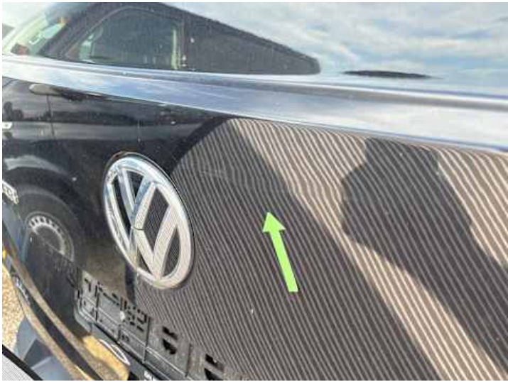
Heckklappe (Delle, Verformung, Kratzer)
