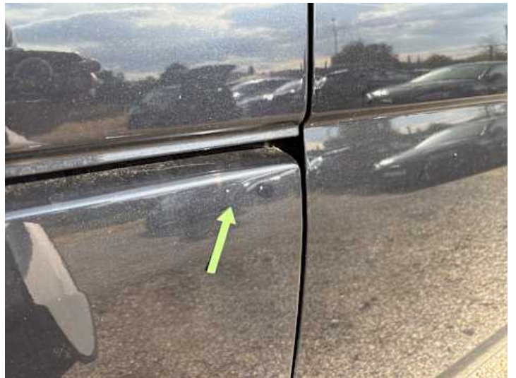
Seitenteil hinten rechts (Lackschaden)
