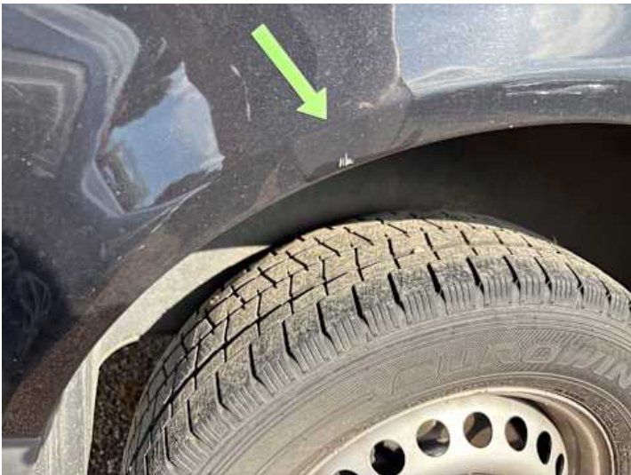
Seitenteil hinten rechts (Lackschaden)
