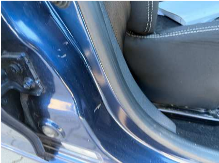
Schweller rechts (Kratzer, Lackschaden)
