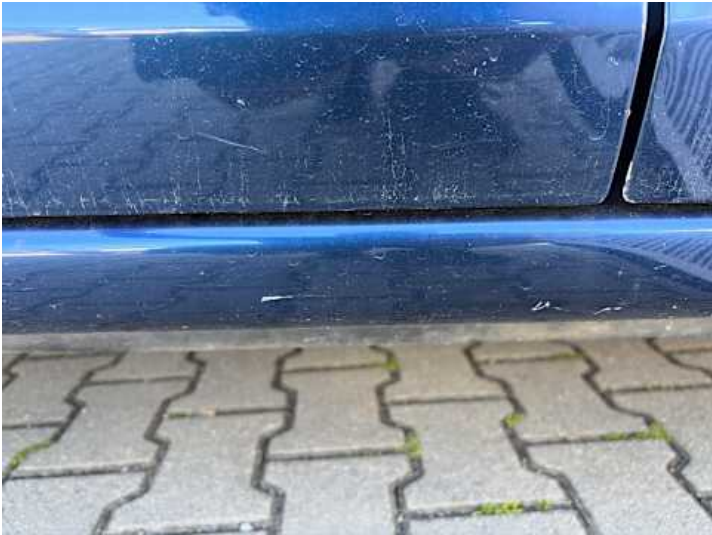
Schweller rechts (Kratzer, Lackschaden)
