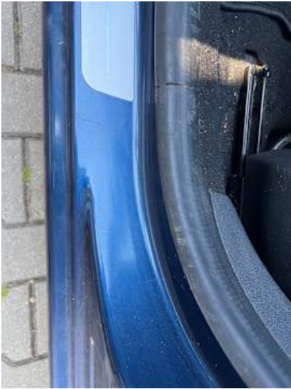
Schweller links (Kratzer)
