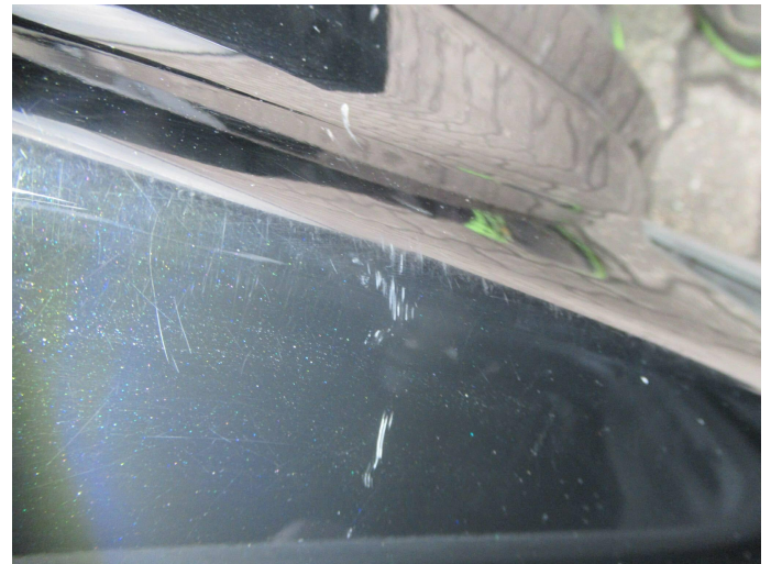
Bild 8: Außen, alle Einstiege, verschrammt, lackieren
