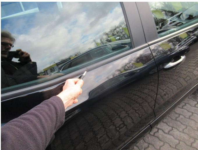
Bild 23: Außen, Seitenscheibe hinten rechts - Schachleiste, verformt, erneuern
