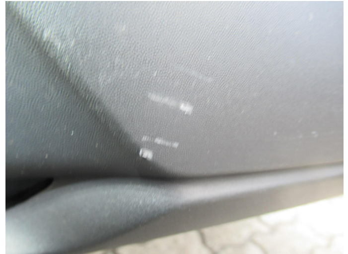
Bild 18: Außen, Heckschürze hinten unten, eingekerbt, erneuern
