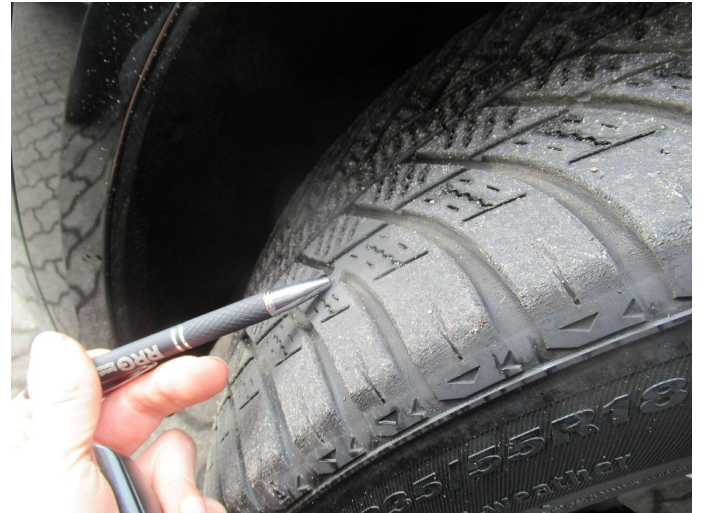
Bild 2: Reifen vorn verschlissen
