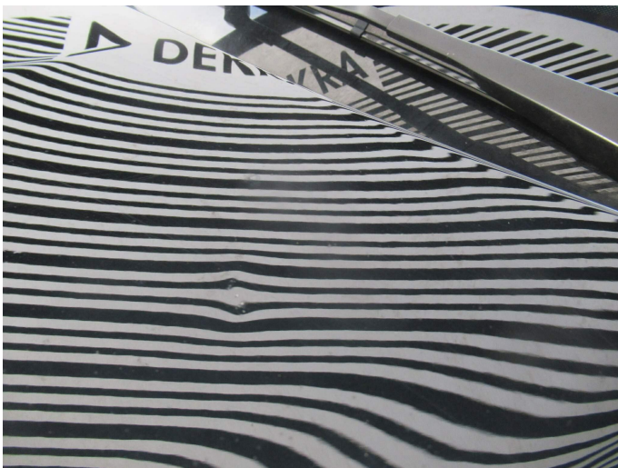
Bild 31: Außen, Motorhaube, deformiert, instandsetzen und lackieren mit Lackaufbau
