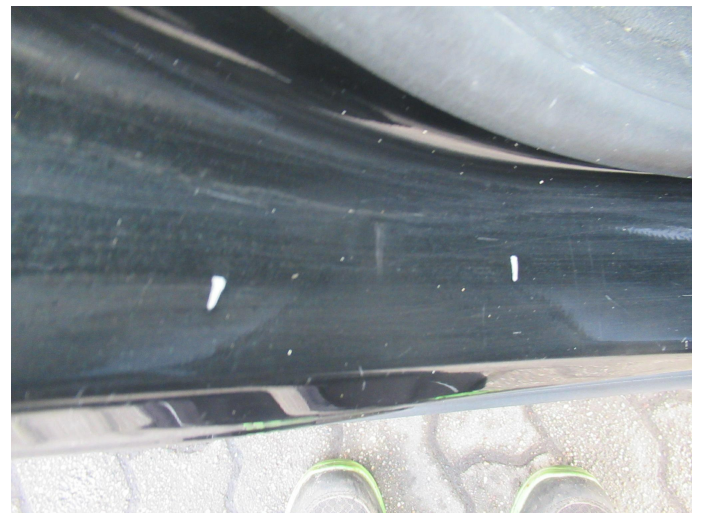
Bild 12: Außen, alle Einstiege, verschrammt, lackieren
