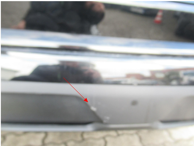
Bild 19: Außen, Heckschürze hinten unten, eingekerbt, erneuern
