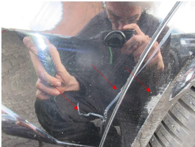
Bild 13: Außen, Stoßfänger hinten - Lackierung, verschrammt, polieren
