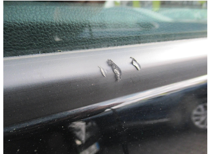
Bild 22: Außen, Seitenteil hinten rechts - Zierleiste - Lackierung, verschrammt, lackieren
