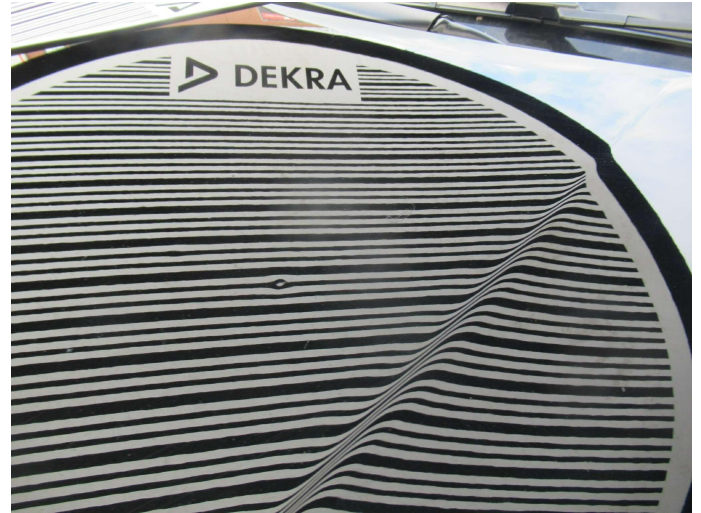
Bild 30: Außen, Motorhaube, deformiert, instandsetzen und lackieren mit Lackaufbau
