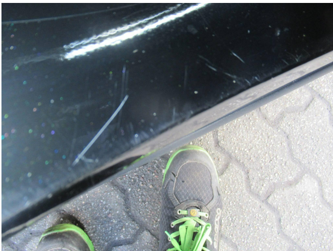
Bild 11: Außen, alle Einstiege, verschrammt, lackieren
