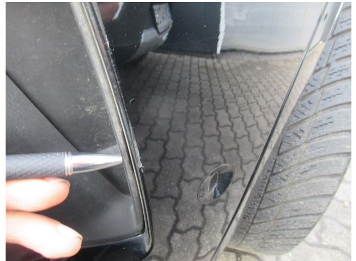
Bild 28: Außen, Stoßfänger vorne, verschrammt, lackieren
