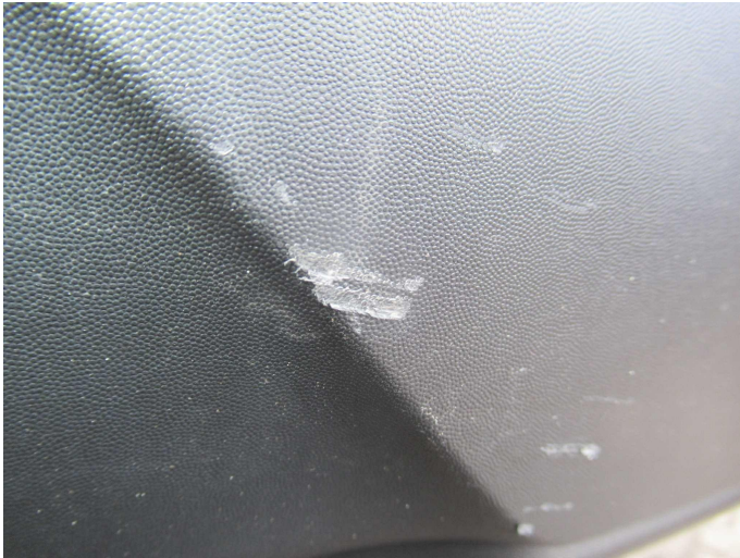
Bild 17: Außen, Heckschürze hinten unten, eingekerbt, erneuern
