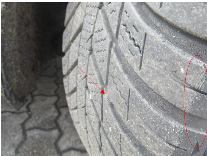
Bild 3: Reifen vorn verschlissen
