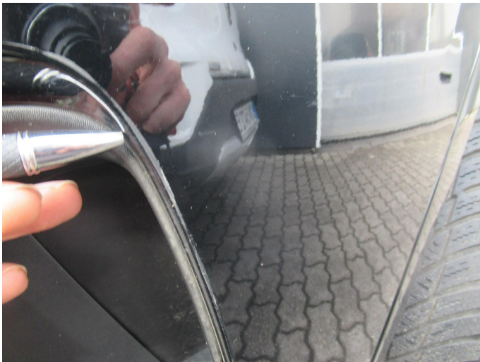
Bild 27: Außen, Stoßfänger vorne, verschrammt, lackieren
