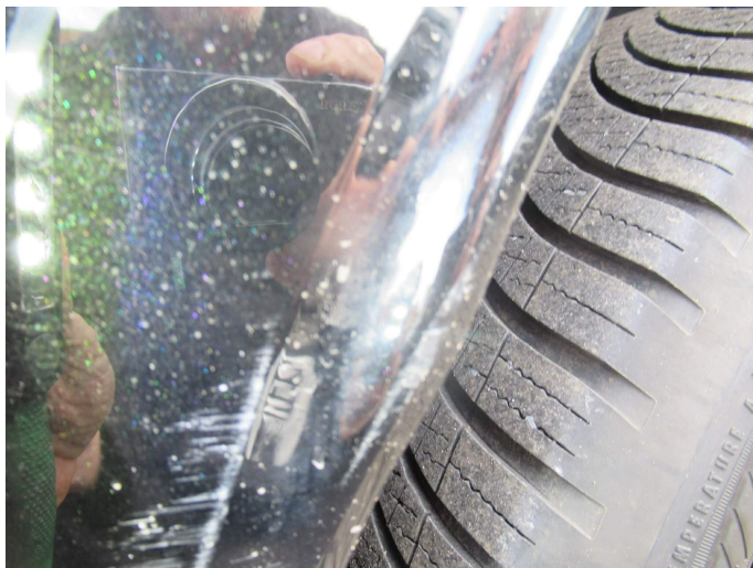
Bild 15: Außen, Seitenteil hinten rechts - Zierleiste - Lackierung, verschrammt, lackieren
