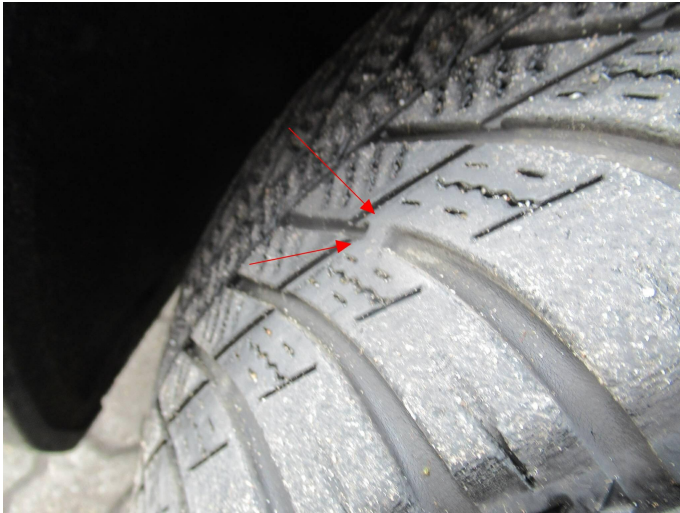
Bild 1: Reifen vorn verschlissen
