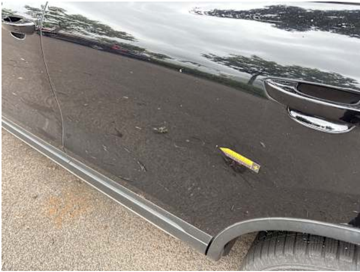
Türe hinten links (Delle, Lackschaden)
