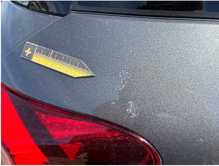
Seitenteil hinten rechts (Lackschaden)
