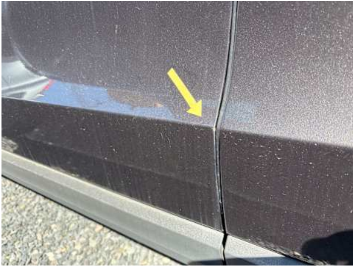
Fahrtür (Rost, Lackschaden)
