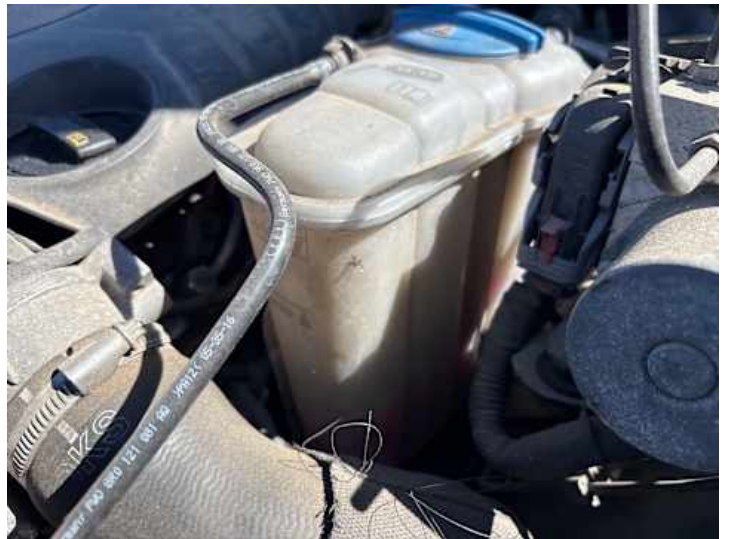
Motorhaube (Anderer Schaden): Kühlmittel unter Minimum
