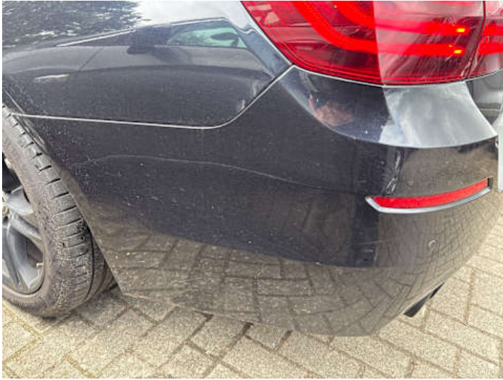
Stoßstange hinten (Kratzer)
