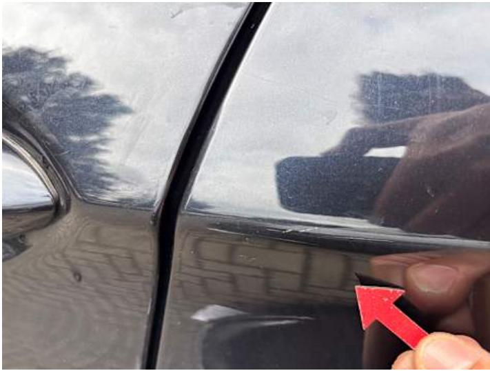
Türe hinten links (Kratzer)
