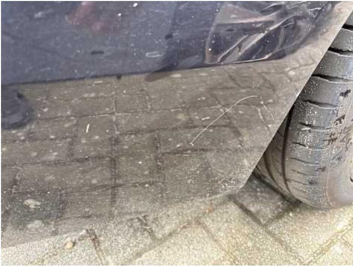
Stoßstange hinten (Kratzer)
