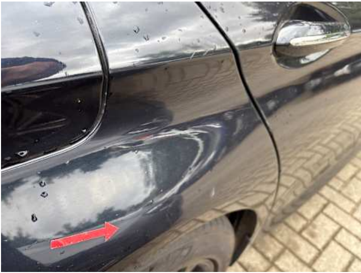
Seitenteil hinten rechts (Kratzer)
