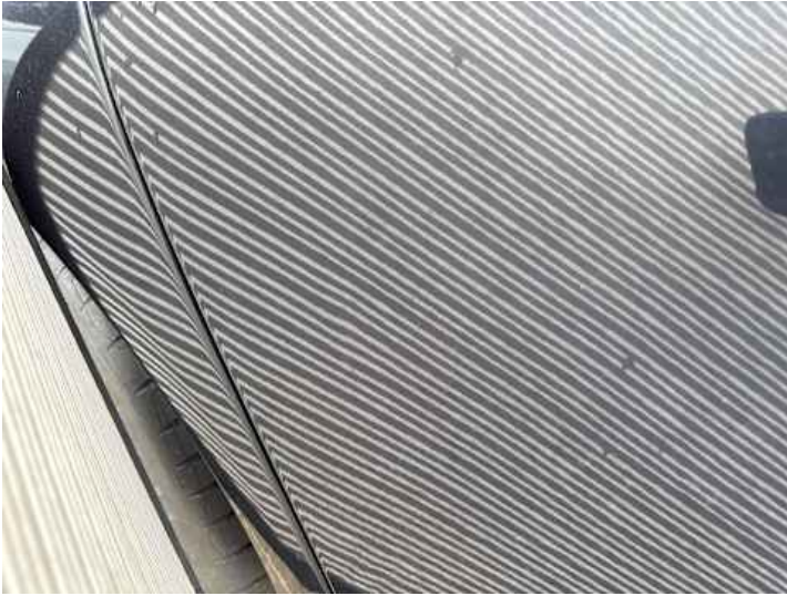
Türe hinten rechts (Delle)
