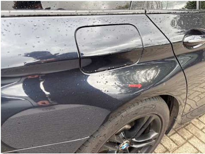
Seitenteil hinten rechts (Kratzer)
