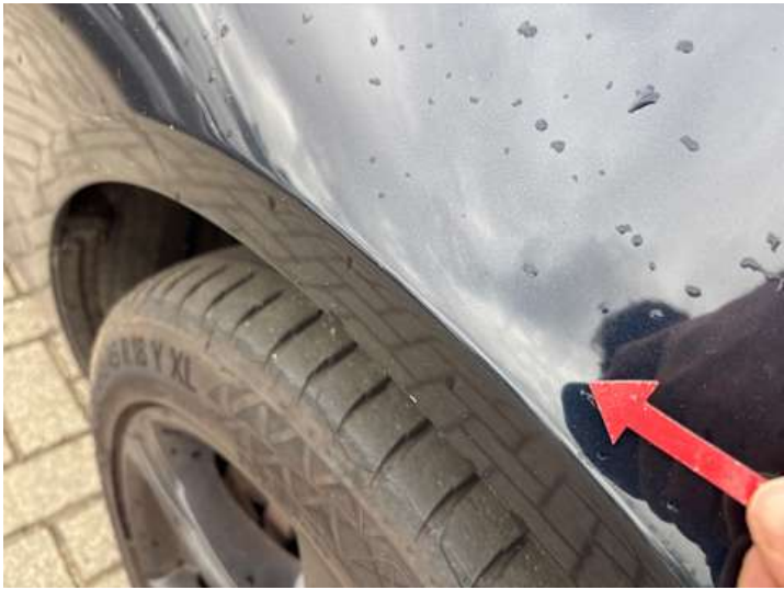
Kotflügel vorne rechts (Kratzer)
