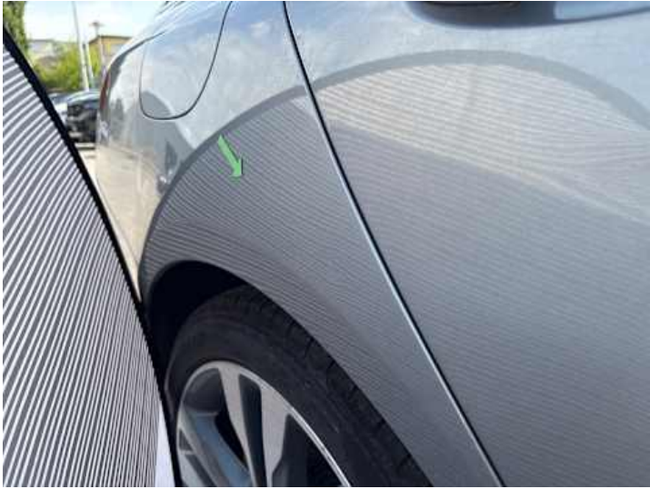
Seitenteil hinten rechts (Delle)
