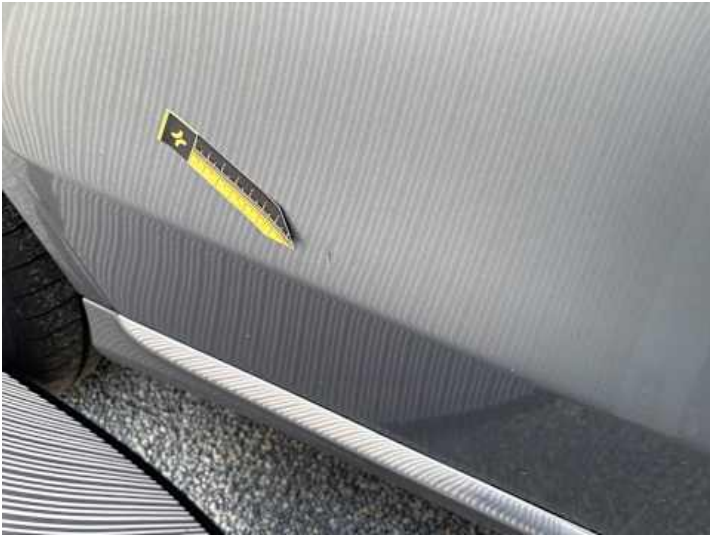
Türe hinten rechts (Kratzer, Delle)
