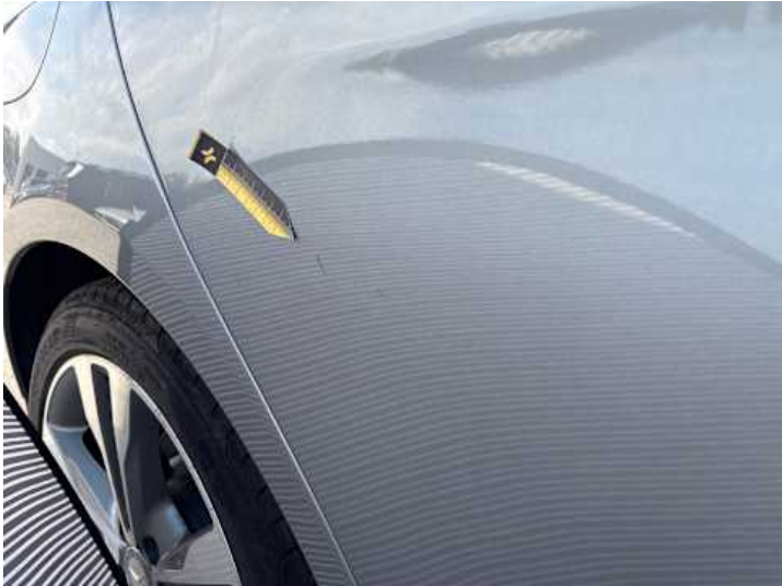
Türe hinten rechts (Kratzer, Delle)
