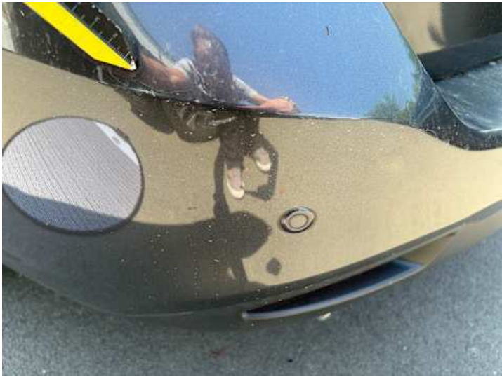
Stoßstange hinten (Lackschaden, Kratzer)
