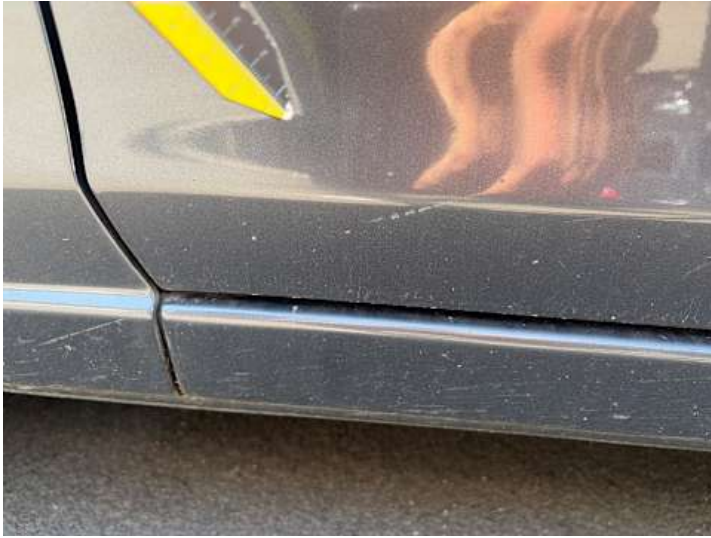
Fahrtür (Lackschaden, Kratzer)
