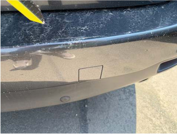
Stoßstange hinten (Lackschaden, Kratzer)
