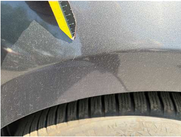
Kotflügel vorne rechts (Lackschaden, Kratzer)
