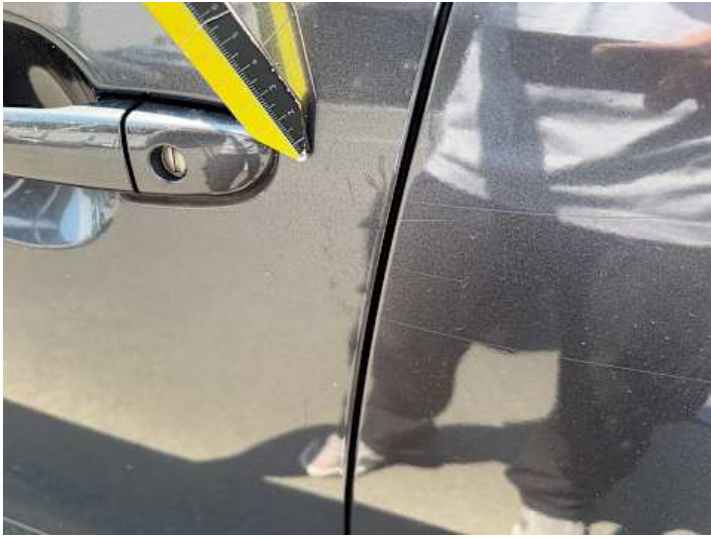
Fahrtür (Lackschaden, Kratzer)
