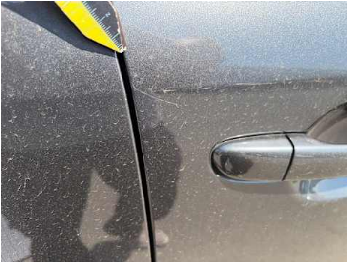
Beifahrertür (Lackschaden, Kratzer)
