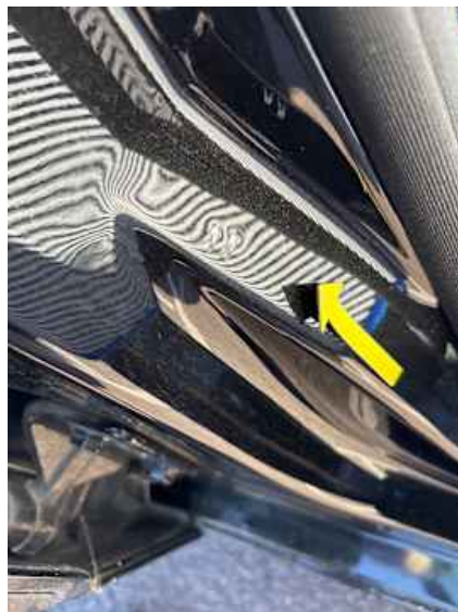
Schweller rechts (Lackschaden, Delle)
