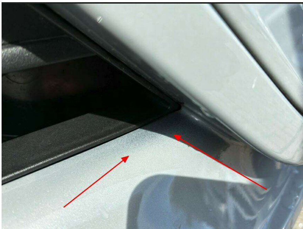
Bild 17 : Frontspoiler nicht fachgerecht Lackiert
