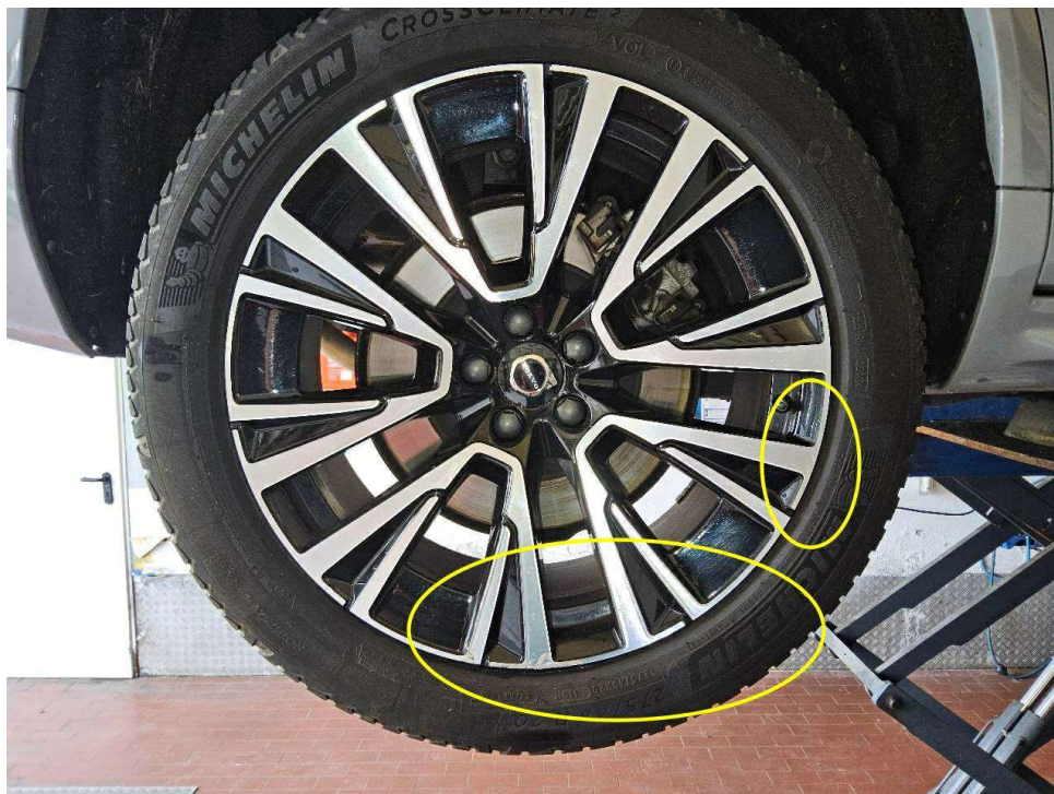
Bild 14 : Glanzgedrehte Felge hinten rechts verschrammt und Lack löst sich
