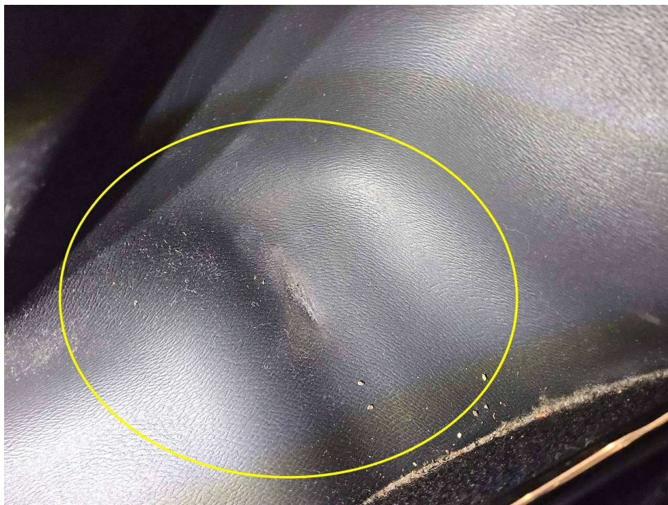
Bild 9 : Türverkleidung vorne links Ablagefach verschrammt
