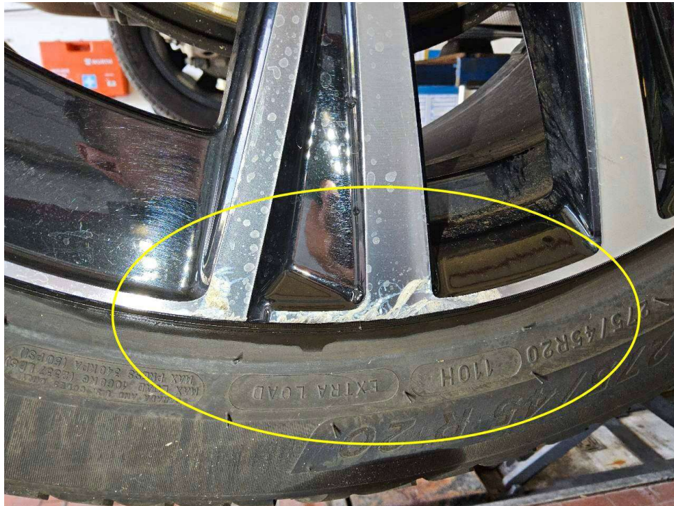
Bild 15 : Glanzgedrehte Felge hinten rechts verschrammt und Lack löst sich
