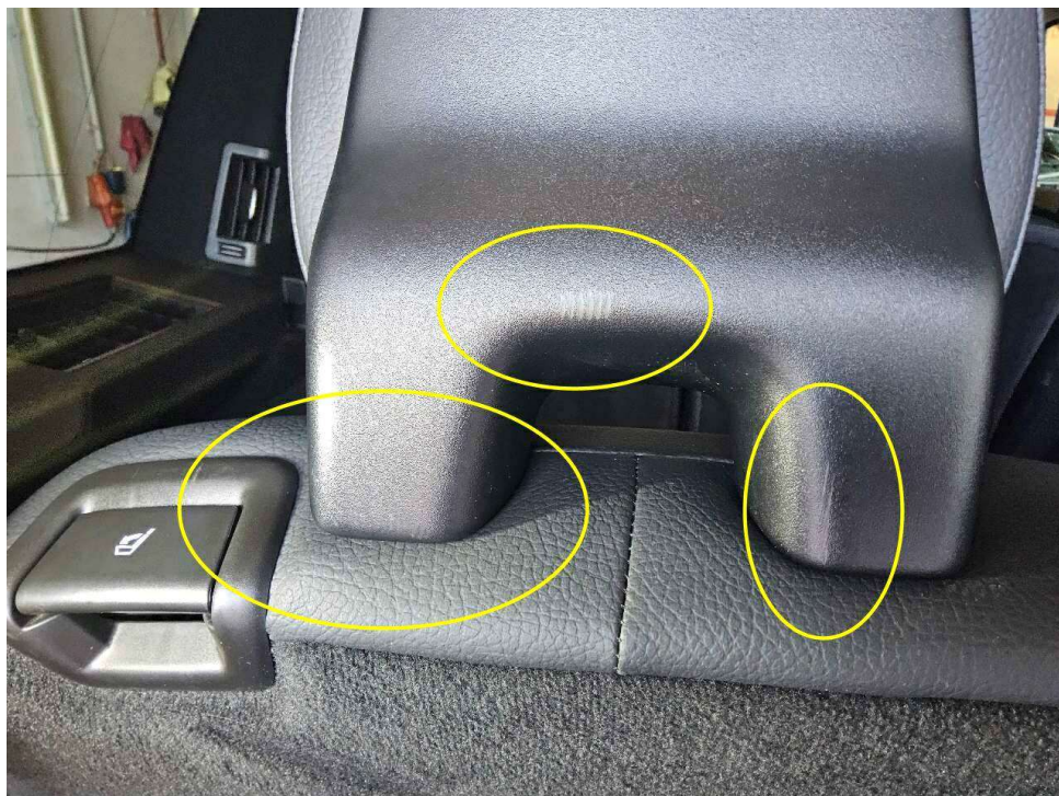
Bild 8 : Kopfstützenverkleidung hinten links verschrammt
