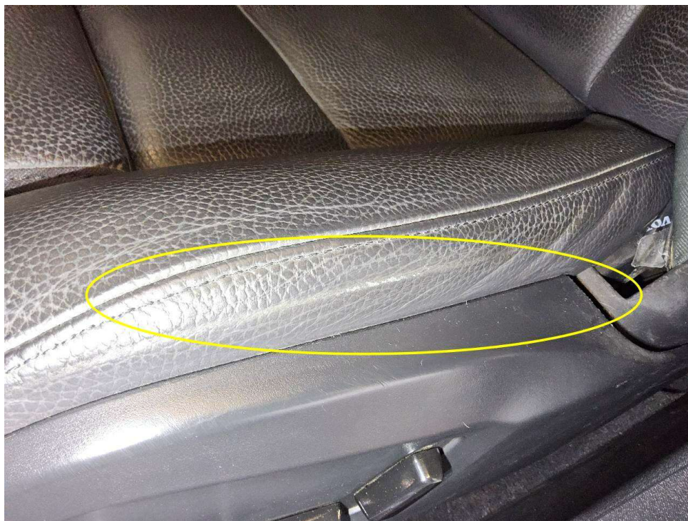
Bild 10 : Sitz vorne links Flanke starke Abnutzung
