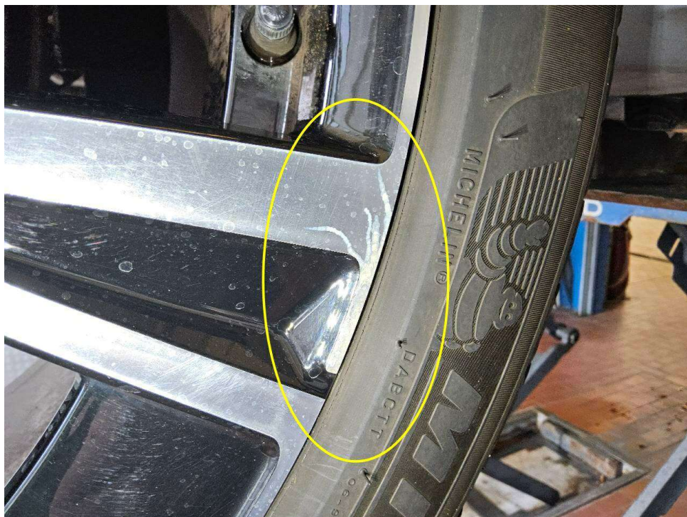
Bild 16 : Glanzgedrehte Felge hinten rechts verschrammt und Lack löst sich
