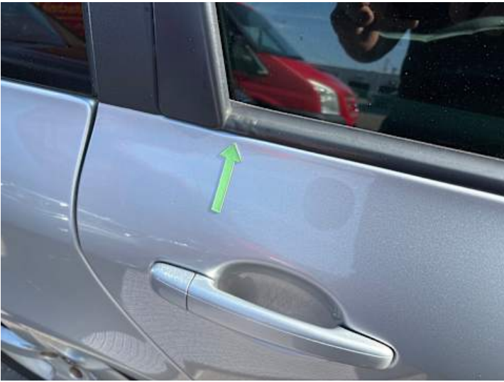
Türe hinten rechts (Rost)
