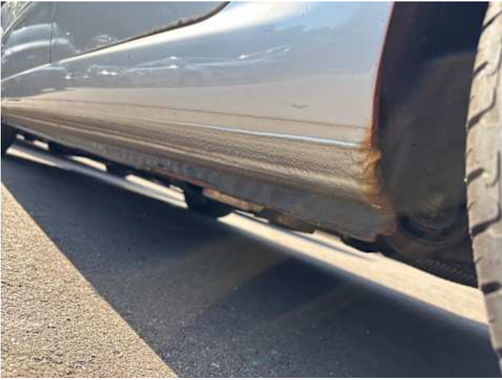
Schweller links (Rost)
