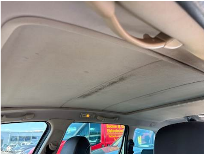
Innenraum (Verschmutzung, Verschleiß)
