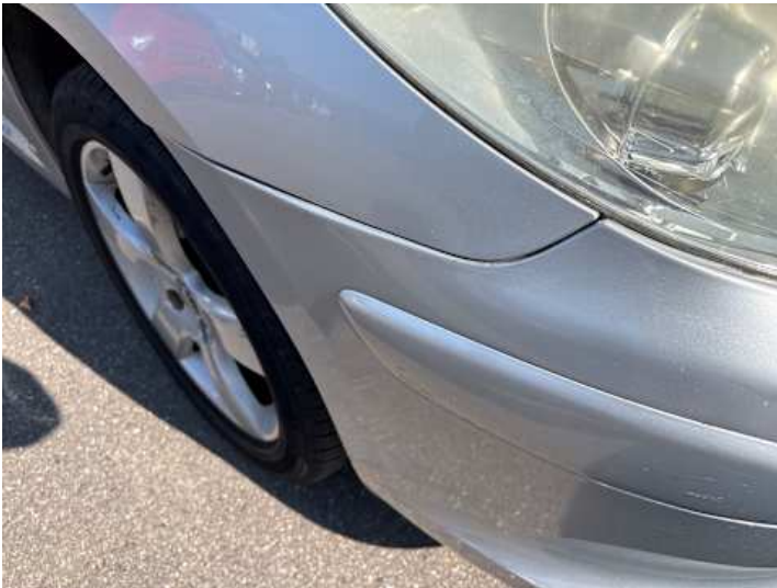
Kotflügel vorne rechts (Spaltmaße ungenau)
