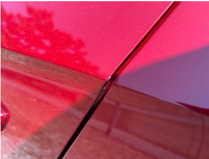
Türe hinten links (Lackschaden)
