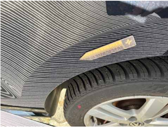
Seitenteil hinten links (Delle)
