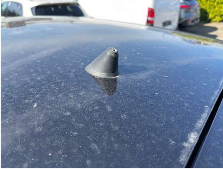
Dach (Anderer Schaden): Antenne fehlt
