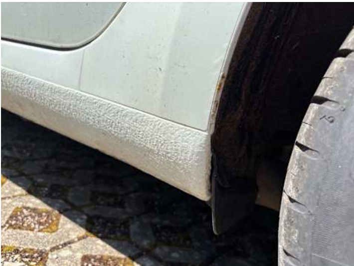
Schweller links (Rost)
