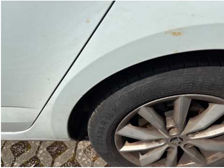
Seitenteil hinten links (Kratzer, Rost)
