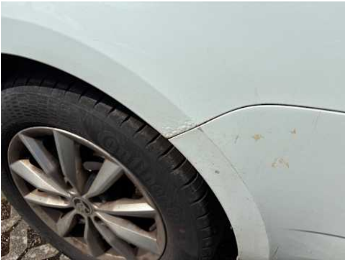
Seitenteil hinten links (Kratzer, Rost)
