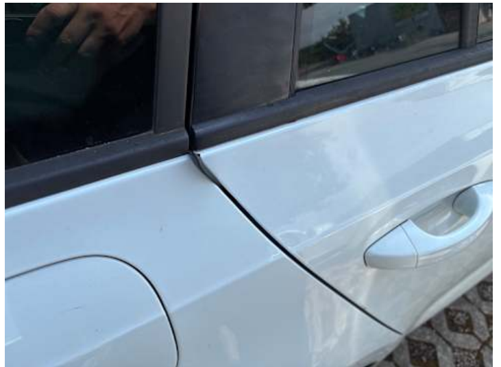
Türe hinten rechts (Anderer Schaden): Dichtung riss
