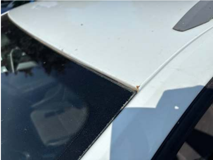
Dach (Steinschlag, Rost)
