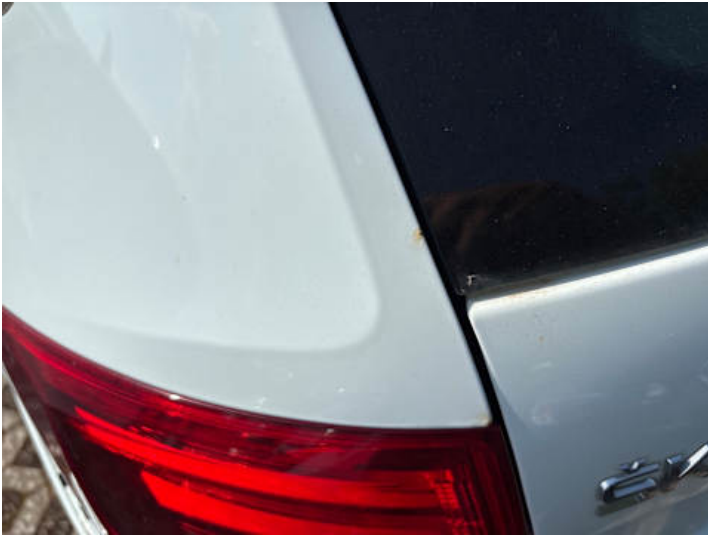
Seitenteil hinten links (Kratzer, Rost)
