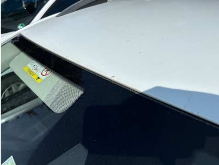
Dach (Steinschlag, Rost)
