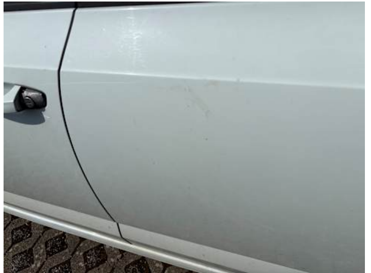
Türe hinten links (Kratzer)
