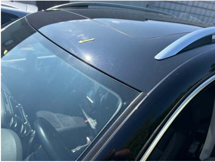
Dach (Lackschaden, Steinschlag)
