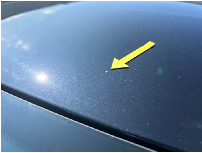
Dach (Lackschaden, Steinschlag)
