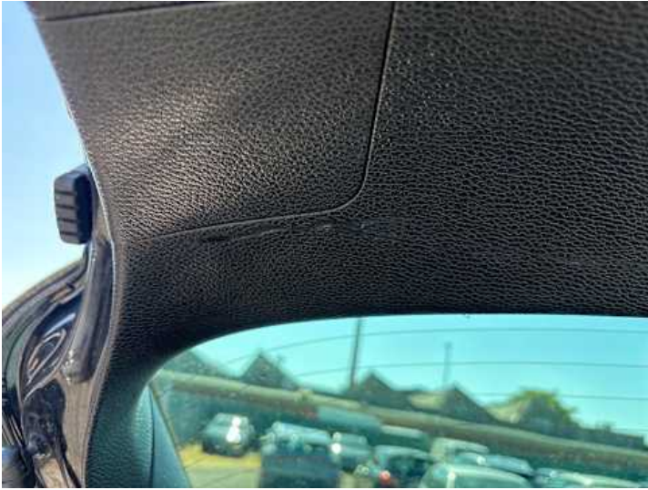
Innenraum (Kratzer, Riss/Bruch)
