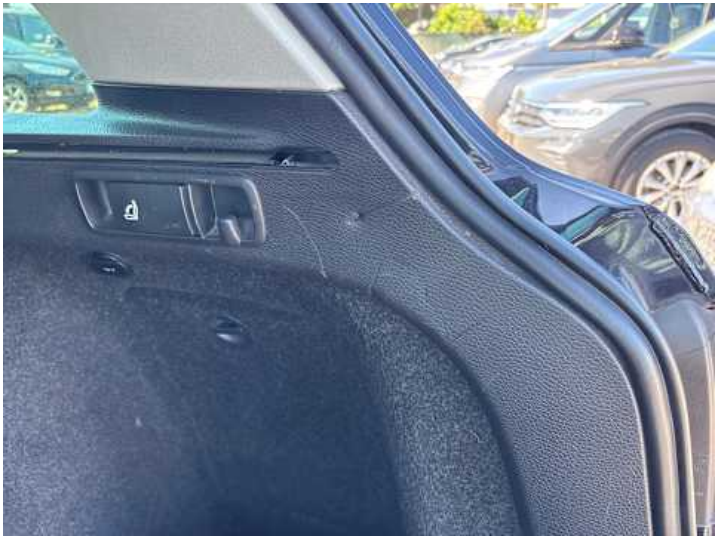
Innenraum (Kratzer, Riss/Bruch)
