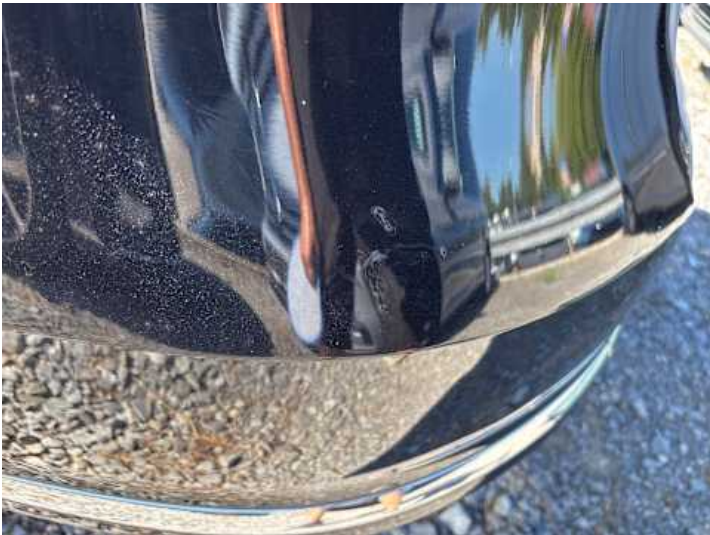
Stoßstange hinten (Kratzer, Lackschaden)
