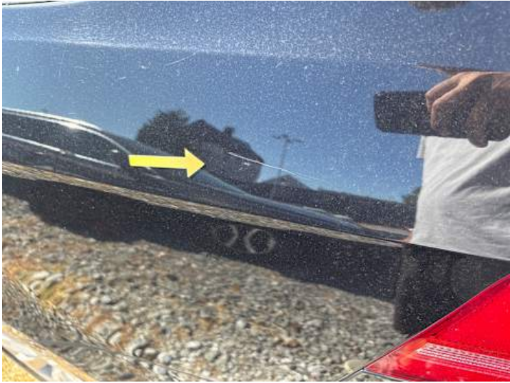
Seitenteil hinten links (Delle, Kratzer)
