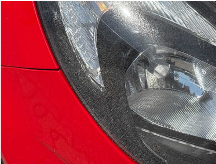
Scheinwerfer (rechts) (Anderer Schaden): Unsachgemäß instandgesetzt
