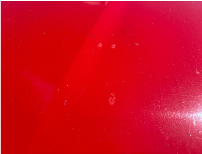
Motorhaube (Steinschlag, Lackschaden)
