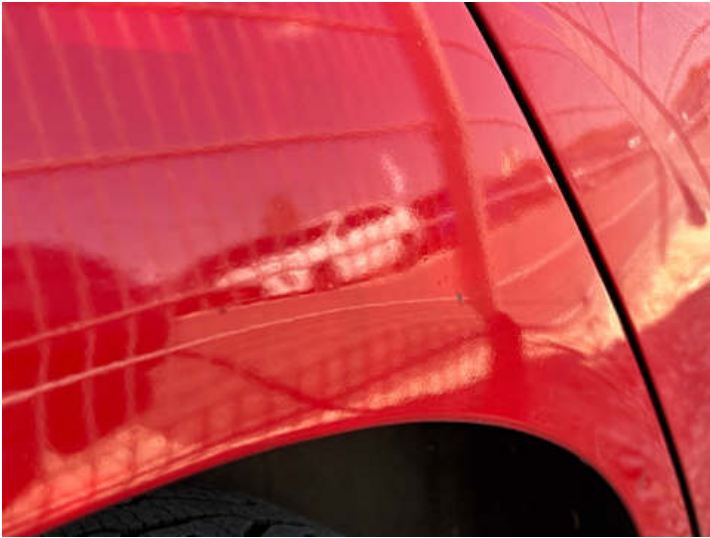
Seitenteil hinten rechts (Unsachgemäß instand gesetzt)
