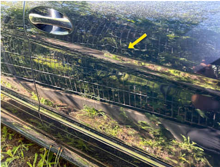
Beifahrtür (Delle, Kratzer)
