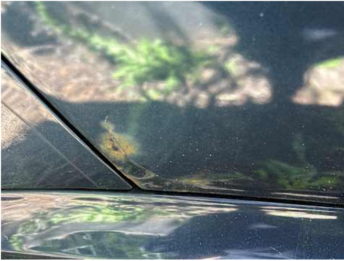
Türe hinten rechts (Kratzer, Rost)
