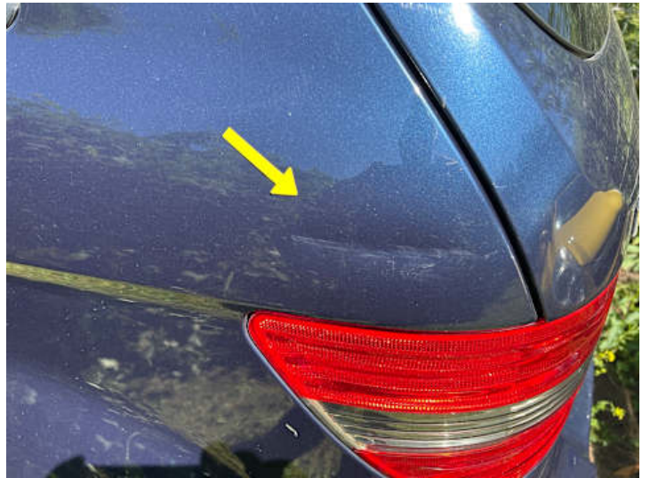
Seitenteil hinten links (Kratzer, Delle)
