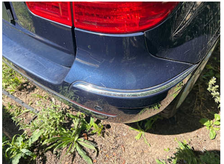
Stoßstange hinten (Kratzer, Verformung, Spaltmaße ungenau)
