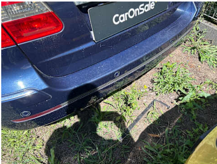
Stoßstange hinten (Kratzer, Verformung, Spaltmaße ungenau)
