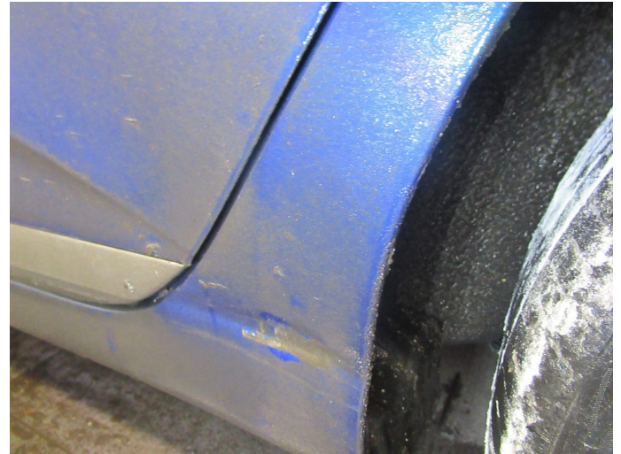
Bild 10: Außen, Streifschaden hinten links, ein separates Schadengutachten, wird benötigt, Pauschale
