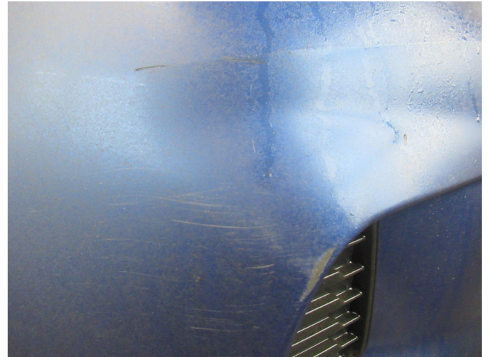
Bild 6: Außen, Streifschaden hinten links, ein separates Schadengutachten, wird benötigt, Pauschale
