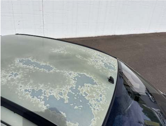
Dach (Lackschaden, Ausgeblichen/Matt)
