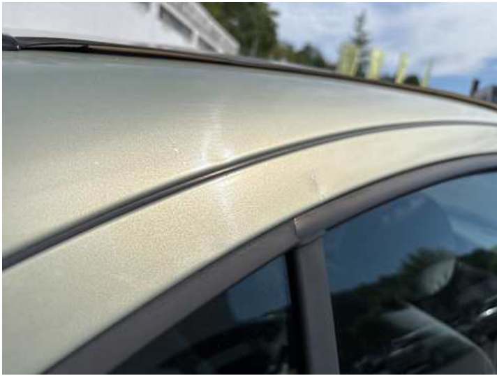
Türe hinten rechts (Lackschaden, Delle)
