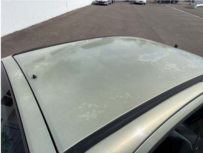
Dach (Lackschaden, Ausgeblichen/Matt)
