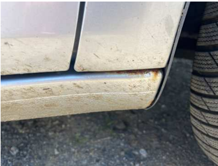
Schweller rechts (Rost)
