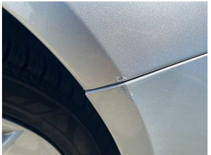
Kotflügel vorne rechts (Lackschaden)
