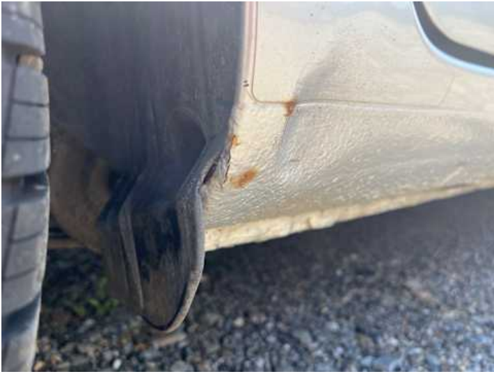
Schweller rechts (Rost)
