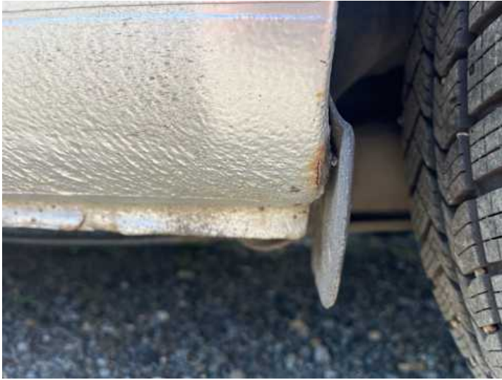
Schweller links (Rost)
