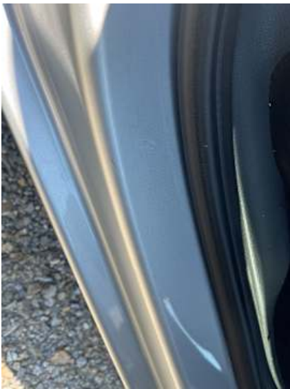
Schweller rechts (Kratzer)
