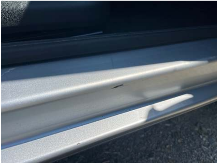
Schweller rechts (Kratzer)
